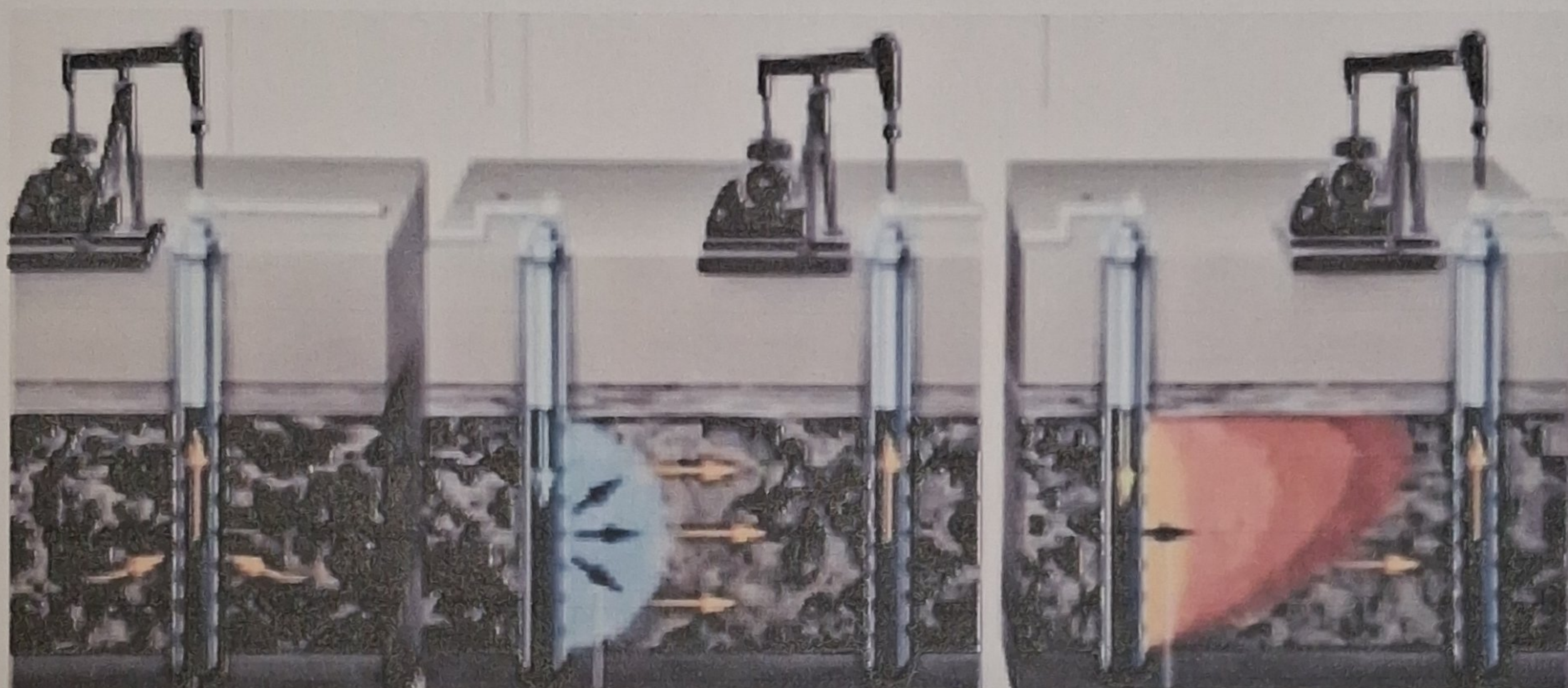
Рисунок 1.1 – Використання первинних (а), вторинних (б) і третинних (в) методів нафто- і конденсатовилучення
