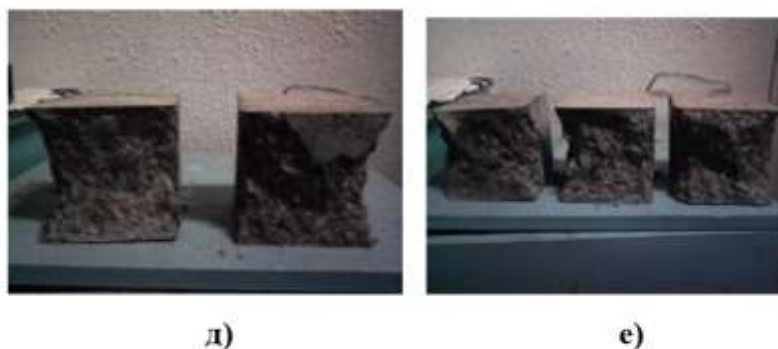
Рисунок 3.11. Етапи проведення визначення міцності стиск зразків - кубів а) встановлення зразків - кубів в металевих формах на віброплощадку для ущільнення; б) зразки - куби в металевих формах після ущільнення; в) зразки - куби після розпалубки; г) встановлення на прес зразка - куба на стиск; д),е) зразки - куби після випробування на пресі.
