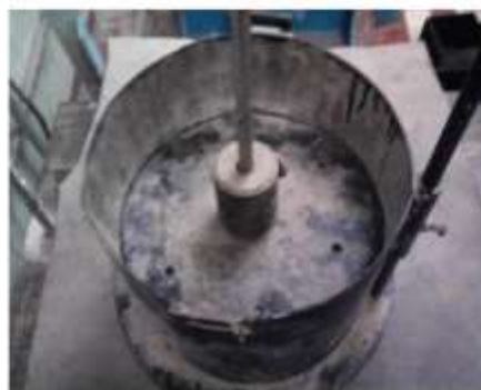
Рисунок 3.8. Випробування жорсткості бетонної суміші методом Красного
