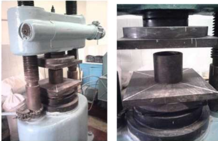
Рисунок. 3.1 Визначення дробимості пресом гідравлічним ПСУ-250
