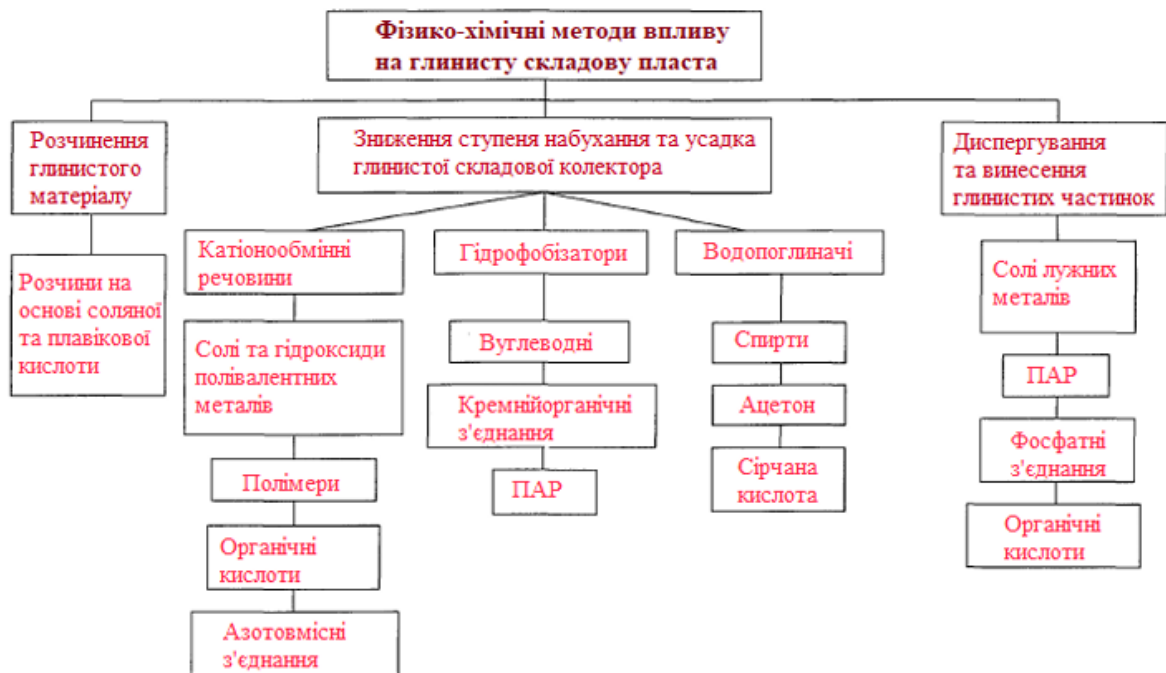
Рис. 1.4. Методи розглинизації привибійної зони пласта
