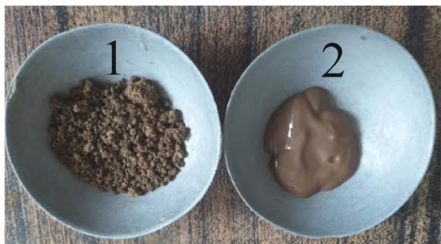
Рис. 1. Загальний вигляд компонентів суміші: 1 – суглинок тугопластичний; 2 – буровий шлам.
