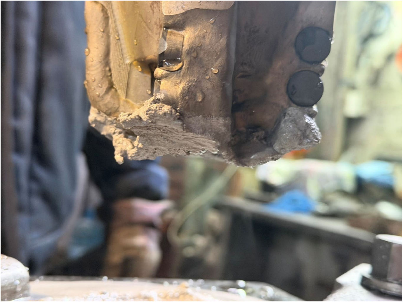
Рисунок 4.18. Спресований шлам сконцентрований в міжлопатевому просторі долота
