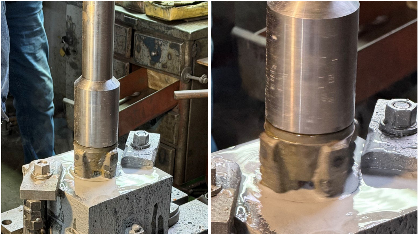
Рисунок 4.17. Руйнування гірської породи при різних режимах обертання та подачі
