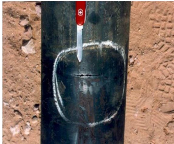
Рисунок 1.5. Втомлювальна тріщина, яка утворилася під дією вигину від зворотного вихрового руху [102]
