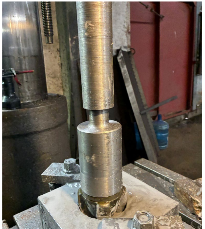
Рисунок 4.21. Буріння проби граніту з пружною муфтою та компоуванням №4
