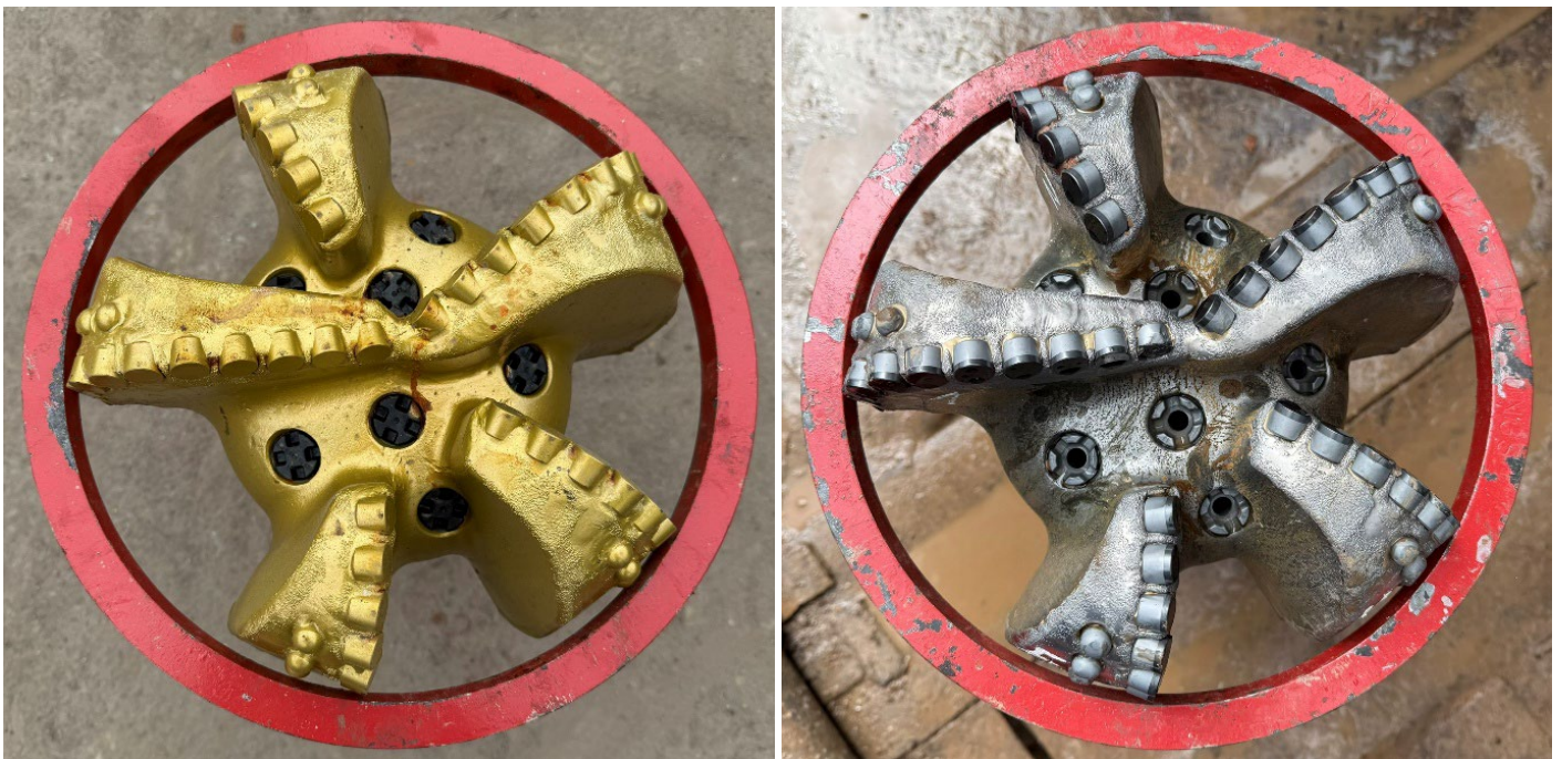
Рисунок 4.8. Долото T505KS: а – нове долото, б – після роботи в свердловині
