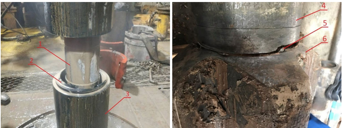
Рисунок 2.4. Злом корпусного перехідника та СТК: а – злом корпусу, б - злом СТК.
