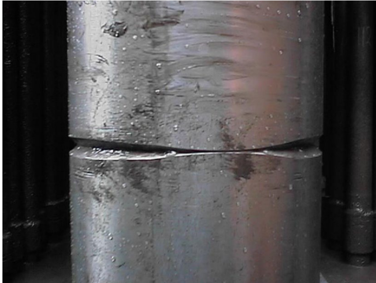
Рисунок 1.7. Плоский знос викликаний прямим синхронним вихровим рухом [17]
