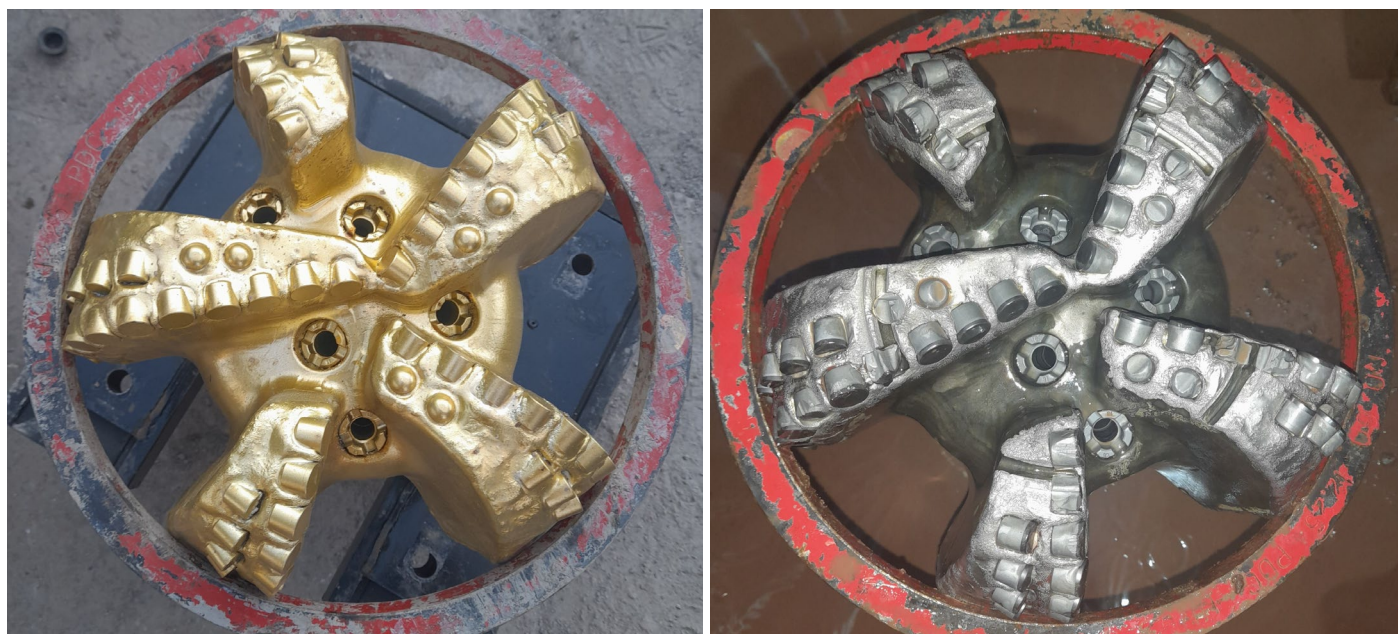
Рисунок 4.7. Долото TD505K SX: а – нове долото, б – після роботи в свердловині
