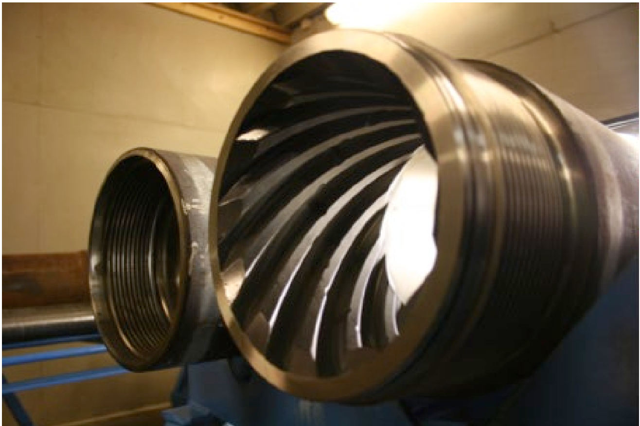
Рисунок 1.19. Механізм передачі крутного моменту Anti Stick-Slip Tool [43]
