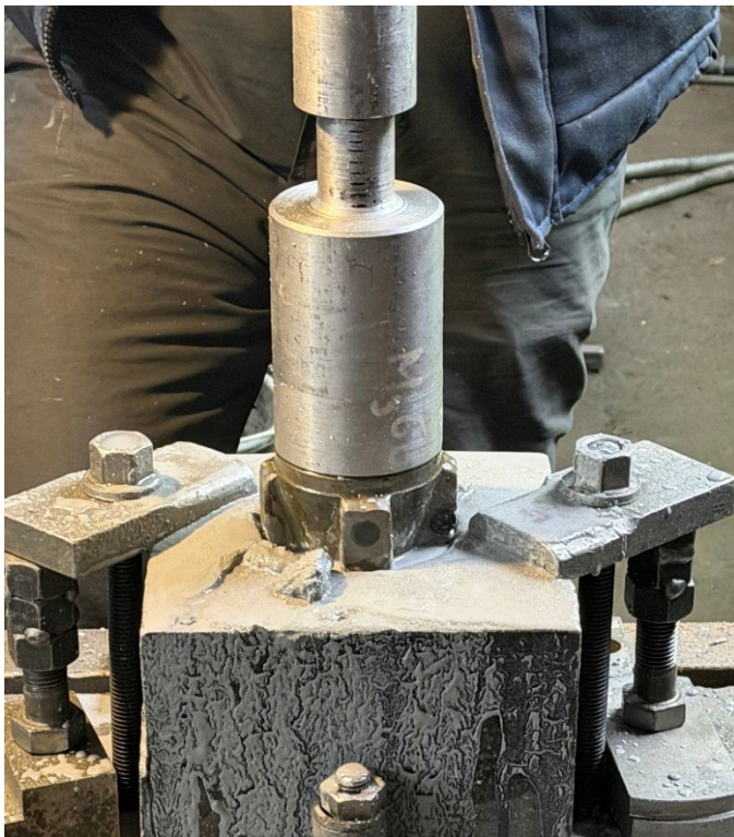
Рисунок 4.21. Буріння проби граніту з пружною муфтою та компоуванням №4
