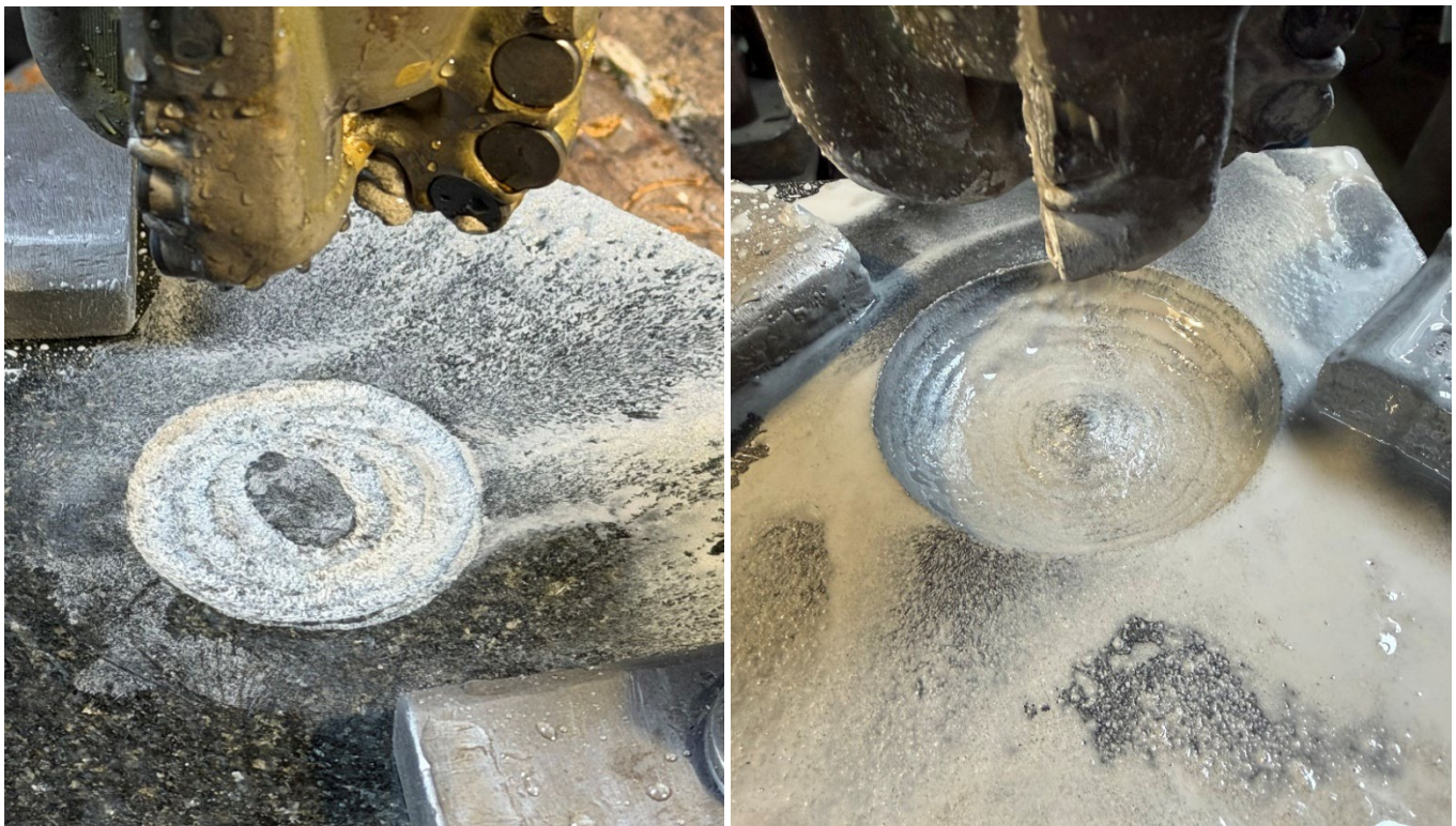
Рисунок 4.20. Формування профілю «вибою» з пружною муфтою
