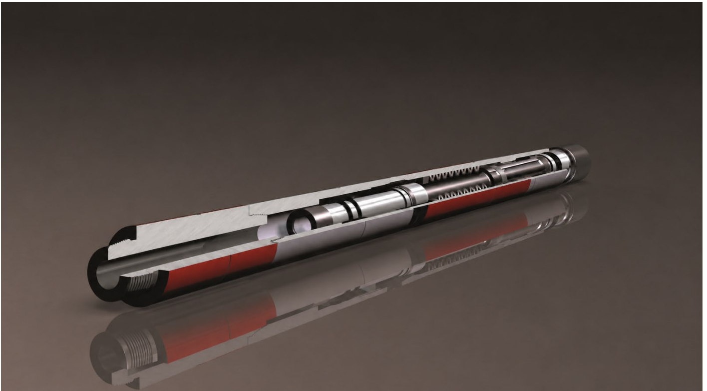
Рисунок 1.14. Ілюстрація амортизатора поздовжніх коливань [103]
