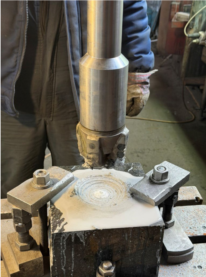
Рисунок 4.16. Профіль вибою сформованого долотом з жорстким з'єднанням з шпинделем верстату
