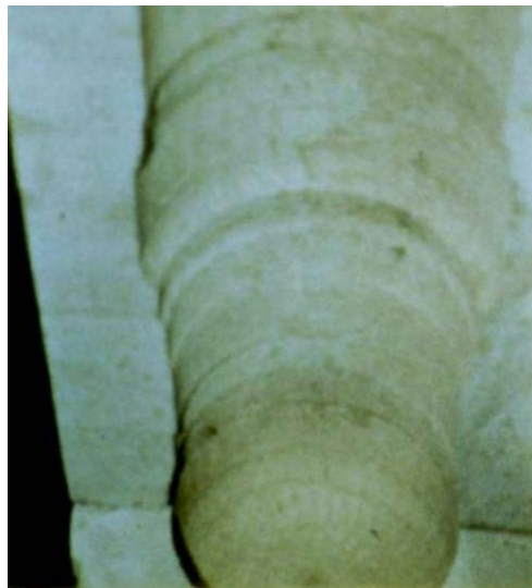
Рисунок 1.3. Профіль стовбура свердловини внаслідок впливу вібрацій [17]
