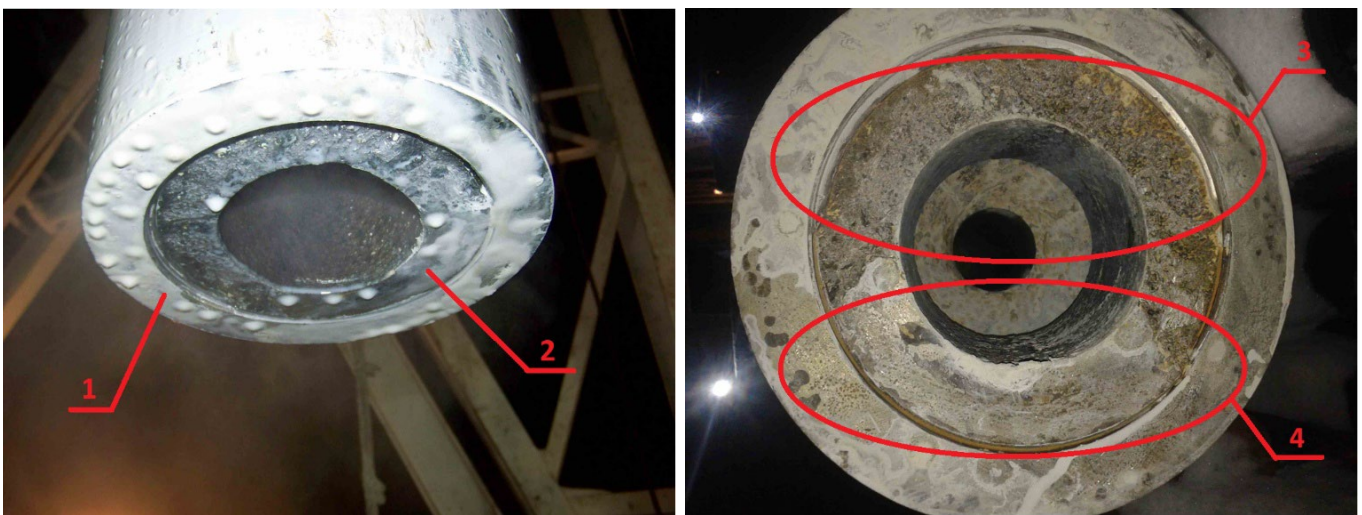
Рисунок 2.1. Злом ніпеля перехідника: а - вигляд збоку, б – вигляд знизу
