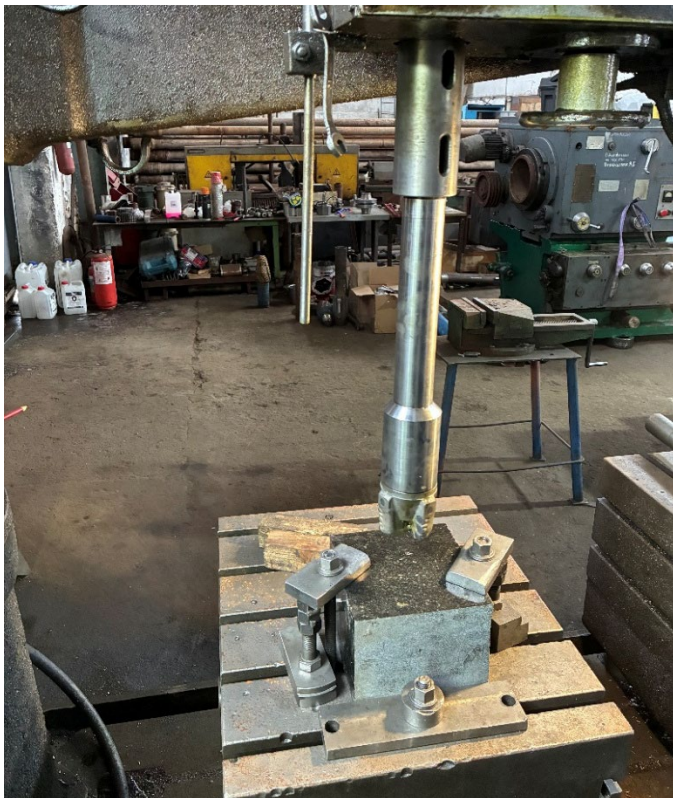
Рисунок 4.15. Свердильний верстат 2А554 з жорстким з'єднанням долота
