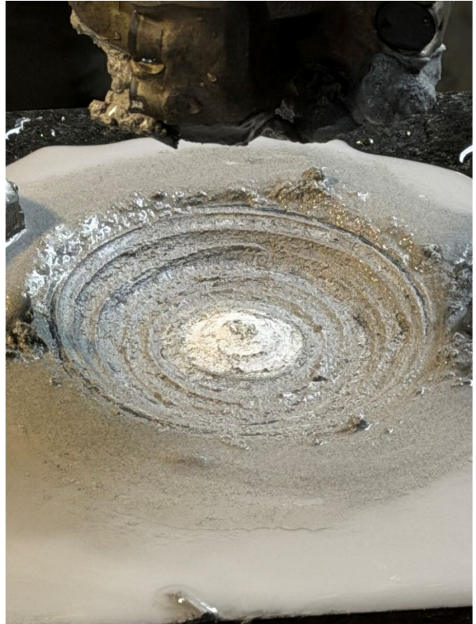
Рисунок 4.16. Профіль вибою сформованого долотом з жорстким з'єднанням з шпинделем верстату
