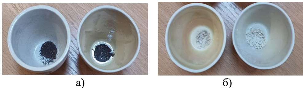
Рисунок 2 – Вміст золи після прожарювання: торфу (а) та паперу й картону (б)
