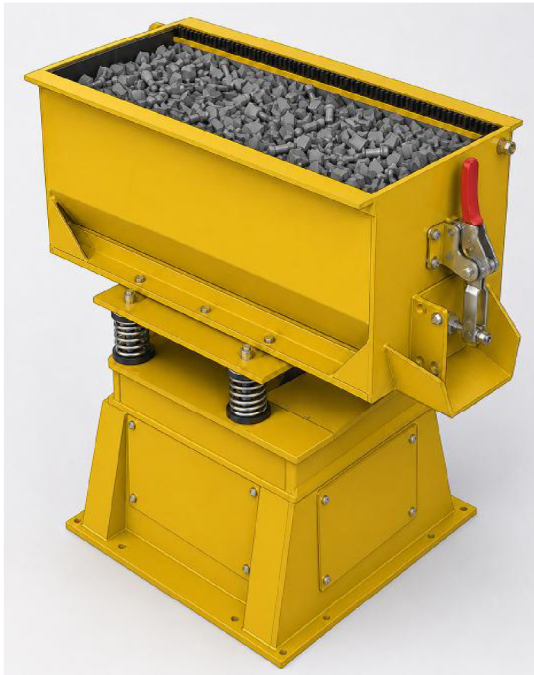
Рис. 1. Загальний вигляд вібраційної установки контейнерного типу для очистки деталей із сірим абразивним наповнювачем
