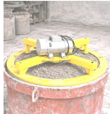
Рисунок 3 Вібраційна установка з привантажувачем Figure 3 Vibration installation with loader
