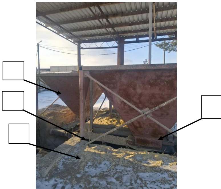
Рис. 3.7. Детальний вид приймального бункера піску досліджуваної БЗУ з встановленим активним розпушувачем: 1 – верхня частина бункера; 2 – конічна
