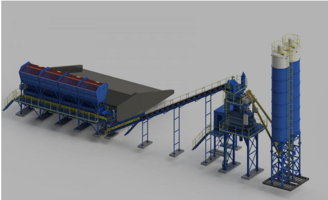
Рис. 4.8. Принципова схема сучасної великогабаритна БЗУ (прототип, 3D-модель): лінійна схема з багатосекційними бункерами заповнювачів (ліворуч), єдиним похилим конвеєром (центр) та силосами цементу (праворуч). Принциповий недолік — єдиний конвеєр, що є «вузьким місцем» технологічного ланцюга
