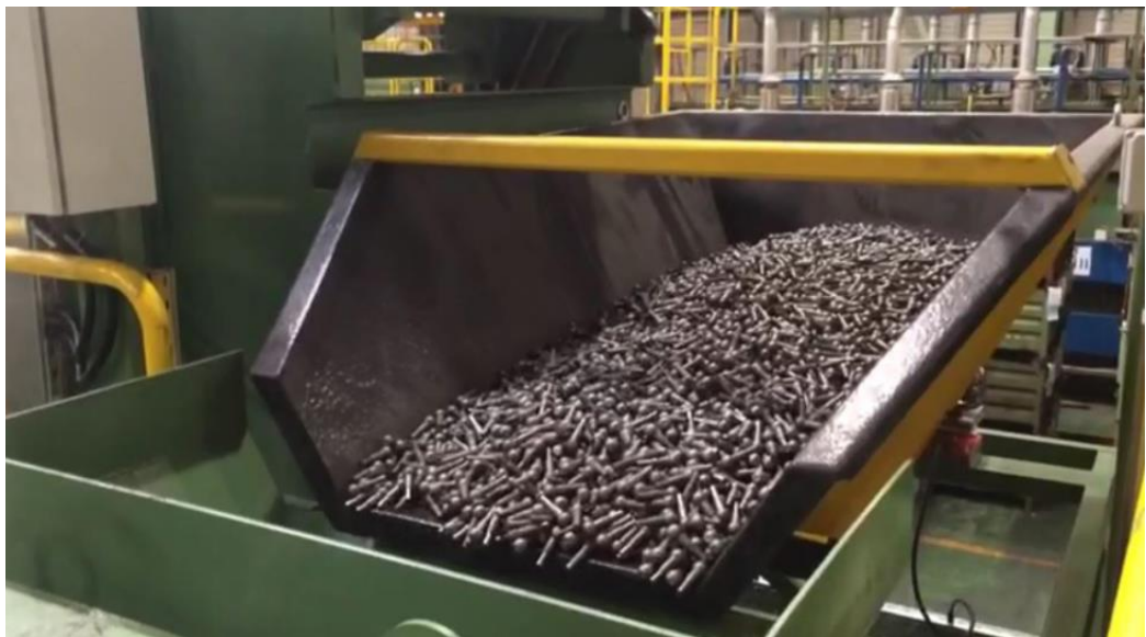
Рисунок 1.5 – Технологічний процес транспортування та дозування заготовок
