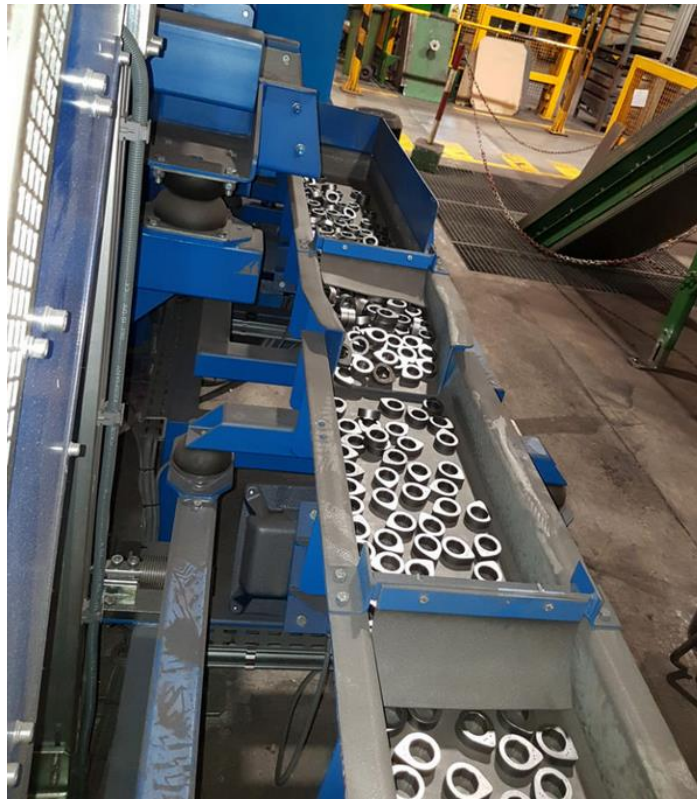
Рисунок 1.4 – Технологічний процес транспортування деталей за допомогою вібраційного конвеєра
