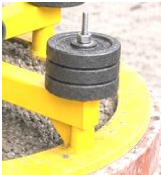
Рисунок 3.7 – Встановлення додаткової маси на привантажувач
