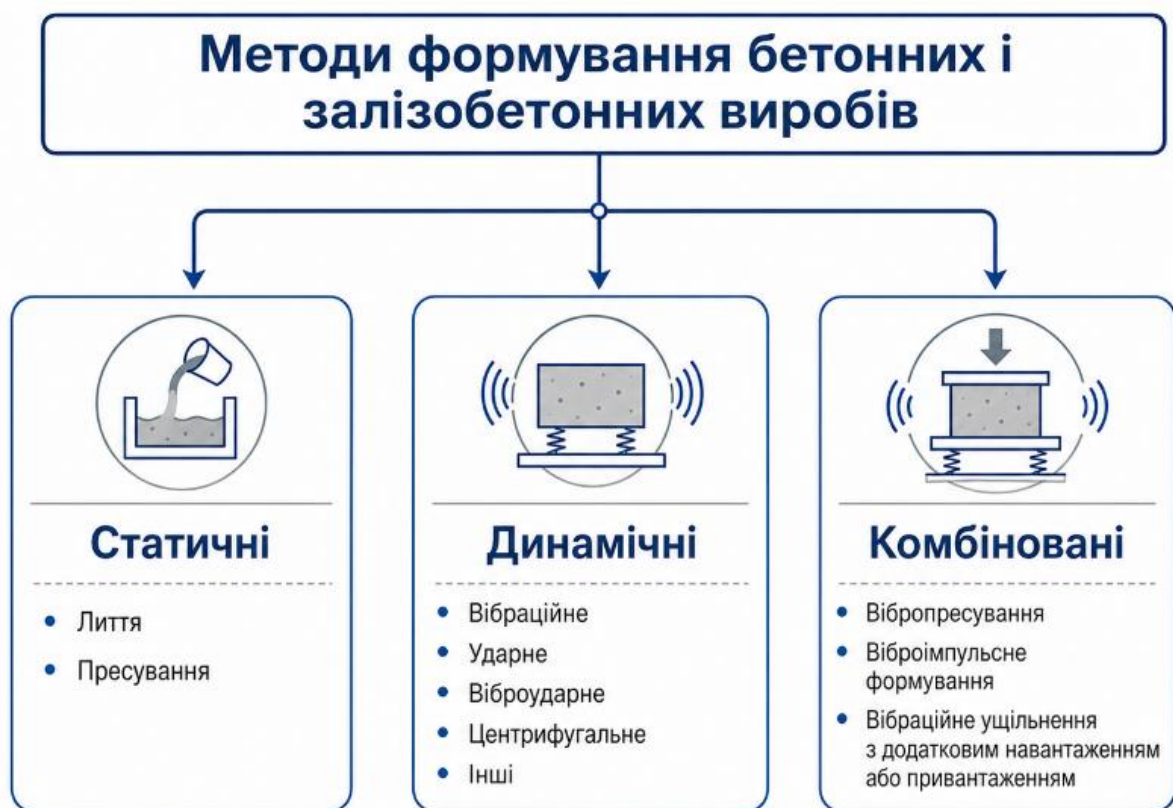
Рисунок 1.1 – Методи формування бетонних і залізобетонних виробів
