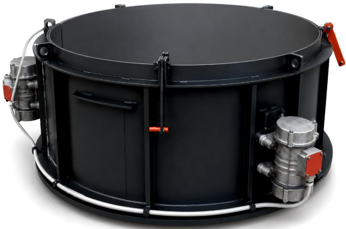
Рисунок 1.9 – Вібраційна форма для виготовлення кілець
