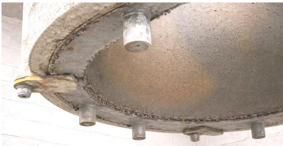
Рисунок 3.6 – Переміщення форми разом з виробом та нижнім кільцем
