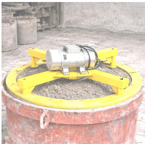
Рисунок 3.2 – Вібраційна установка з привантажувачем
