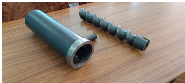
Рисунок 4.2 – Конструкція робочого гвинта зі зміненою геометрією профілю гребеня
