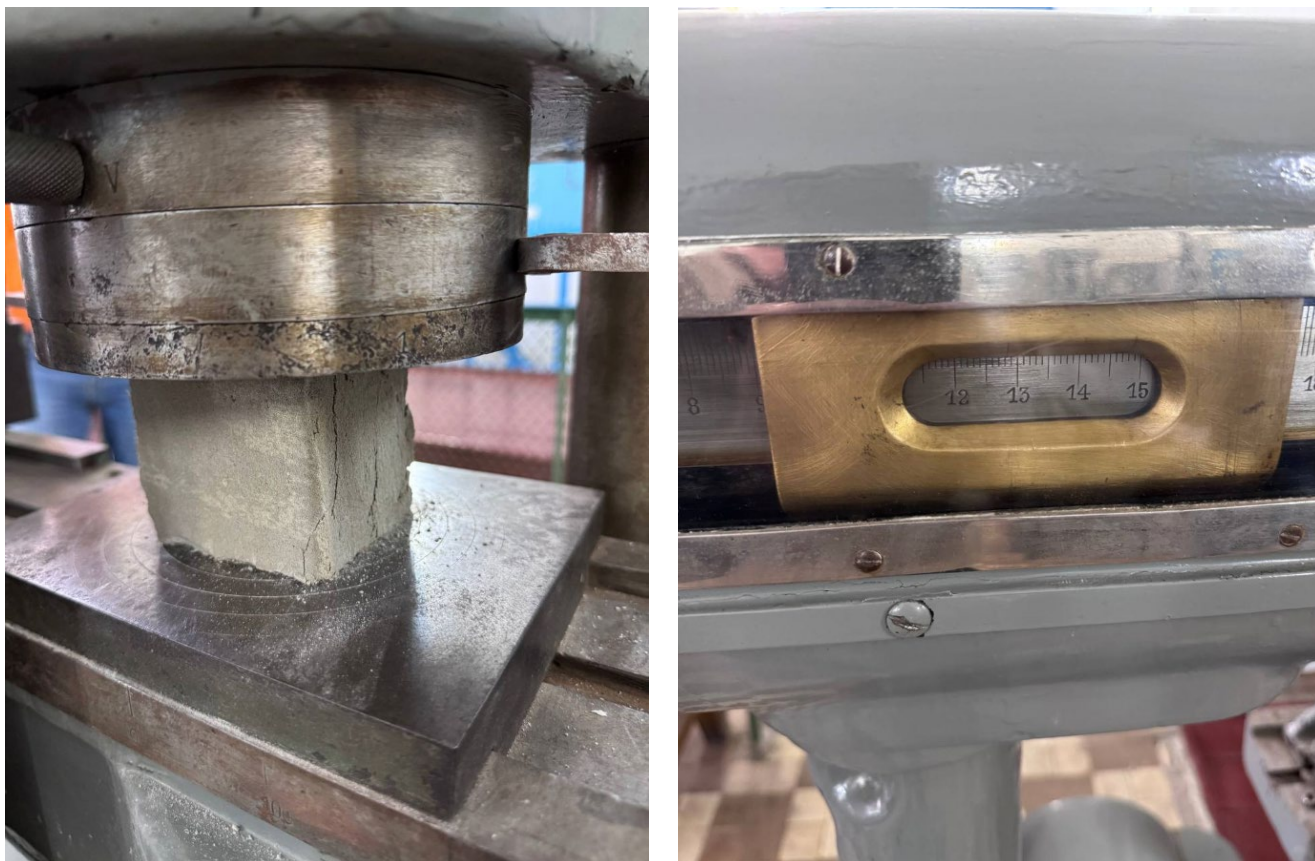
Рисунок 3.19 – Випробування зразків будівельного розчину на стиск
