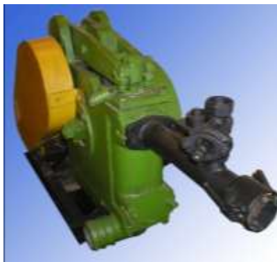
Рисунок 1.4 – Принципові схеми та зображення однопоршневих диференціальних розчинонасосів: а – одноплунжерний; б – РН 2-4; в – РН 3,8
