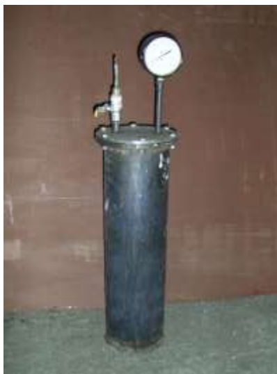
Рисунок 3.8 – Стенд дослідження насичення провітрям вільної камери компенсатора
