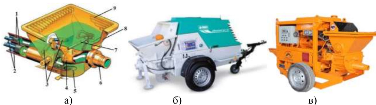
Рисунок. 1.9 – Схема та зображення поршневих бетононасосів з гідравлічним приводом: а) схема двопоршневого бетононасоса з S-шибером: 1 – поршні; 2 – гідроциліндри; 3 – циліндри перемикання шибера; 4 – S-шибер; 5 – зливний клапан; 6 – бетоновод; 7 – вал змішувача бункера; 8 – завантажувальний бункер; 9 – решітка бункера; б) Imer Booster 15; в) АльпСервис АС-6.
