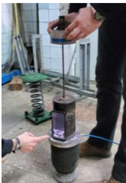
Рисунок 3.25 – Процес зняття діаграм затухання.
