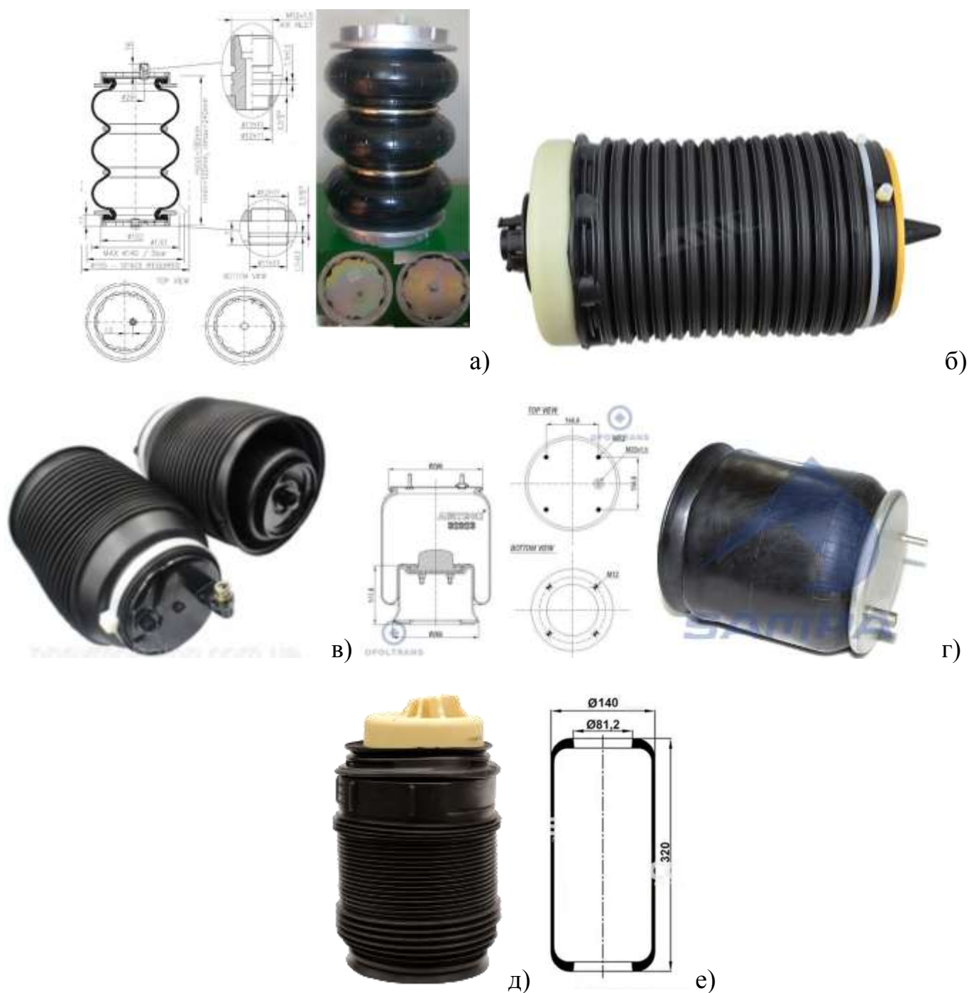
Рисунок 1.21 – Пневмобалони: а) пневморессора 3В-300 для вантажних НУД; б) пневмобалони (пневмоподушки) гофровані ATC Air Suspension Products (Пневмобаллон задний левый Audi A7 Sportback (2011-2018)); в) пневмоподушка задня ліва MATOMI 48090-35011; г) пневморессора зі стаканом (пластик) (виробництво Sampra) SP 554156-KP; д) пневмобалон (пневмоподушка) для автомобіля Mercedes-Benz, моделі E Class, серії W212 виробництва польської компанії Limak; е) пневмоподушка (балон) Mercedes 975N, W010950437 320x81.2x140 (975N) (Contech | 97500)
