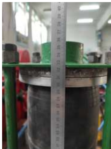
Рисунок 3.7 – Визначення початкових лінійних розмірів пружних елементів
