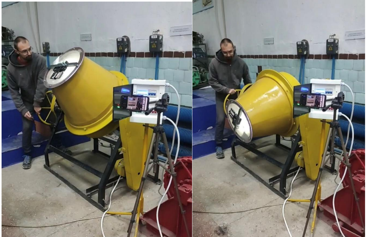
Рисунок 4.1 – Дослідний зразок бетонозмішувального обладнання з осциляційним рухом барабана
