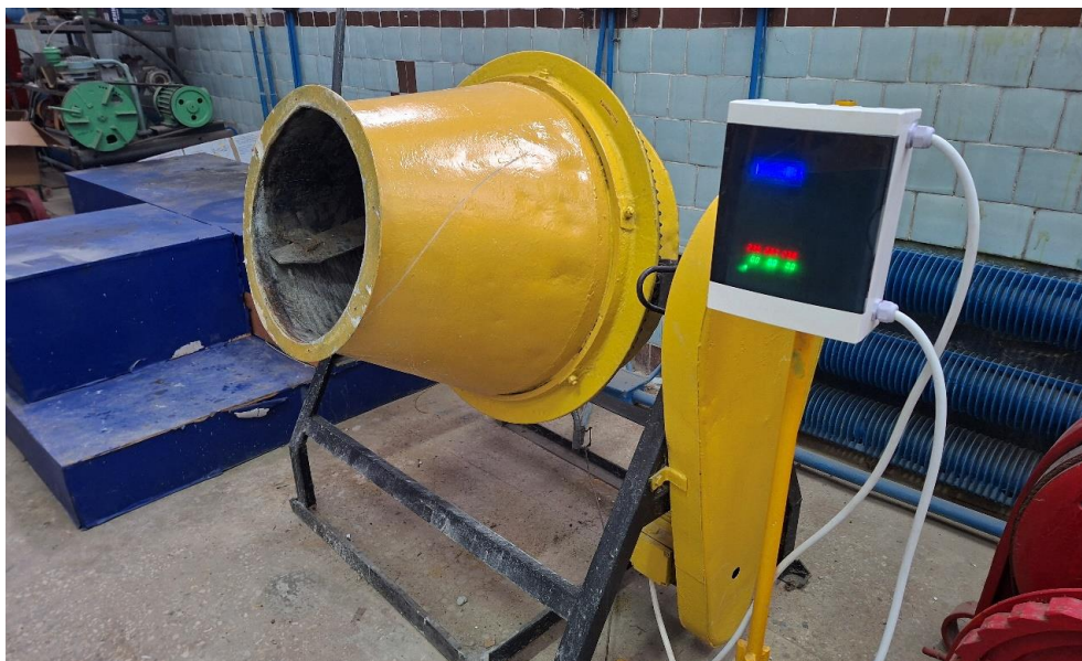
Рисунок 3.12 – Гравітаційний бетонозмішувач та засіб вимірювання споживаної потужності
