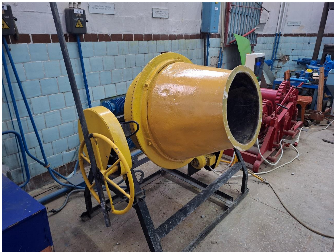
Рисунок 3.1 – Стенд гравітаційного бетонозмішувача з осциляційним рухом барабана
