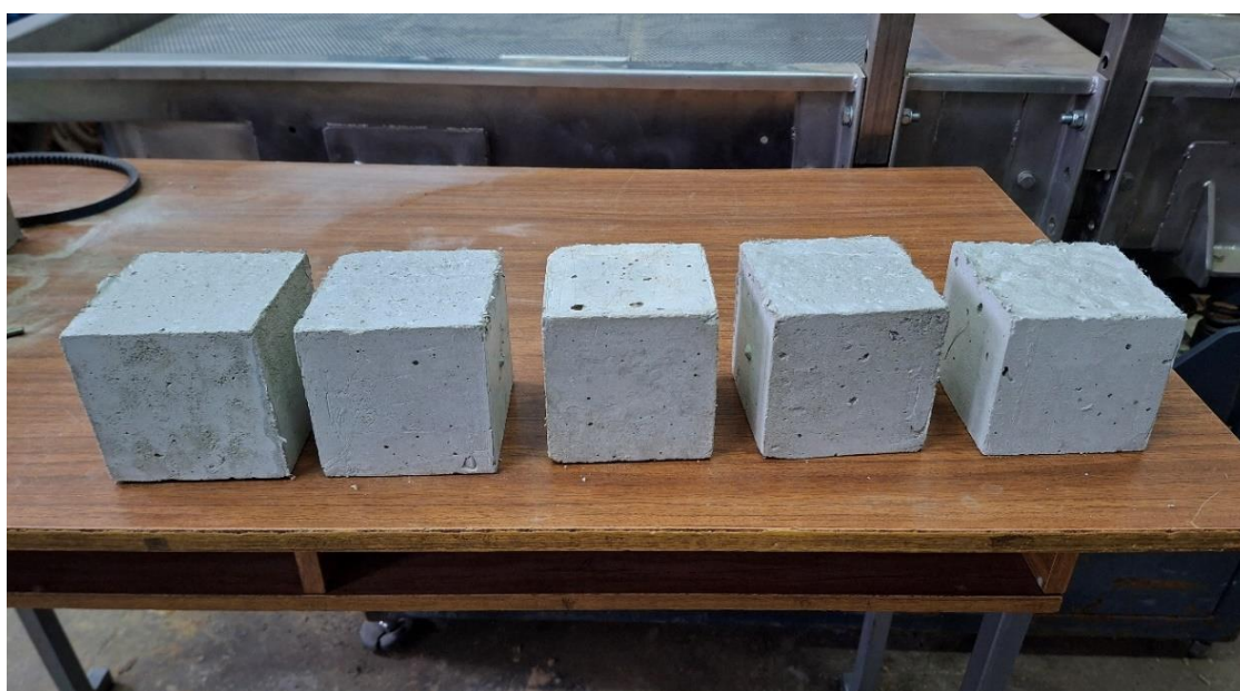
Рисунок 3.11 – Контрольні зразки-куби для випробування бетону на стиск
