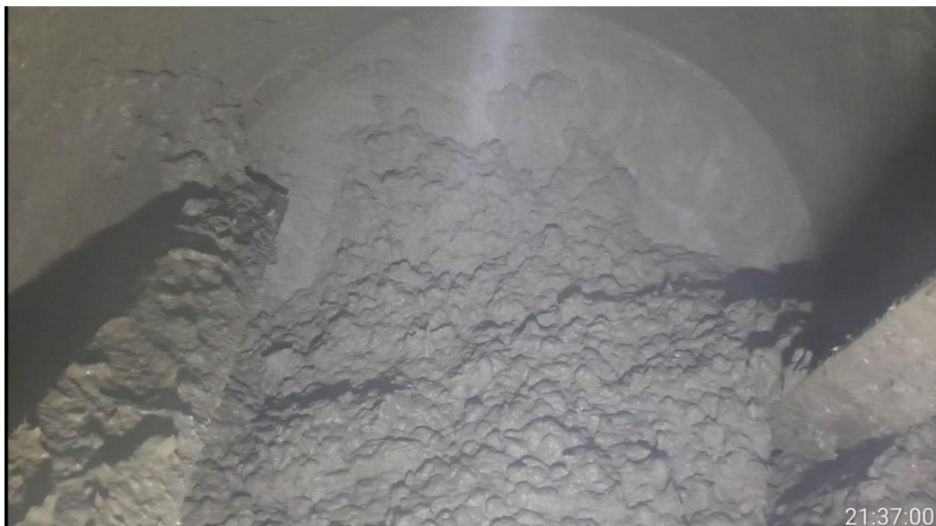
Рисунок 4.2 – Стан бетонної суміші у барабані після змішування з періодичною зміною кута нахилу
