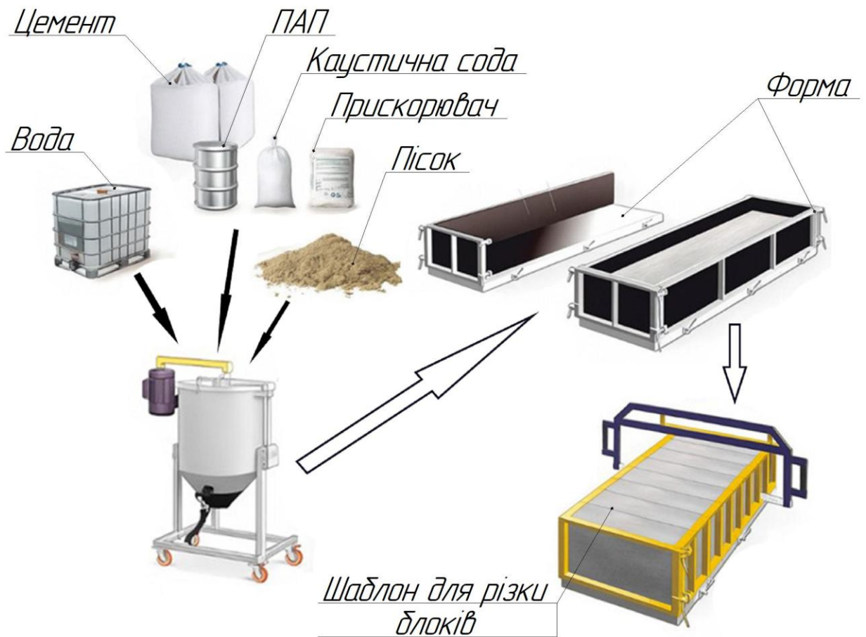
Рисунок 1.4 – Схема організації виготовлення неавтоклавного ніздрюватого бетону
