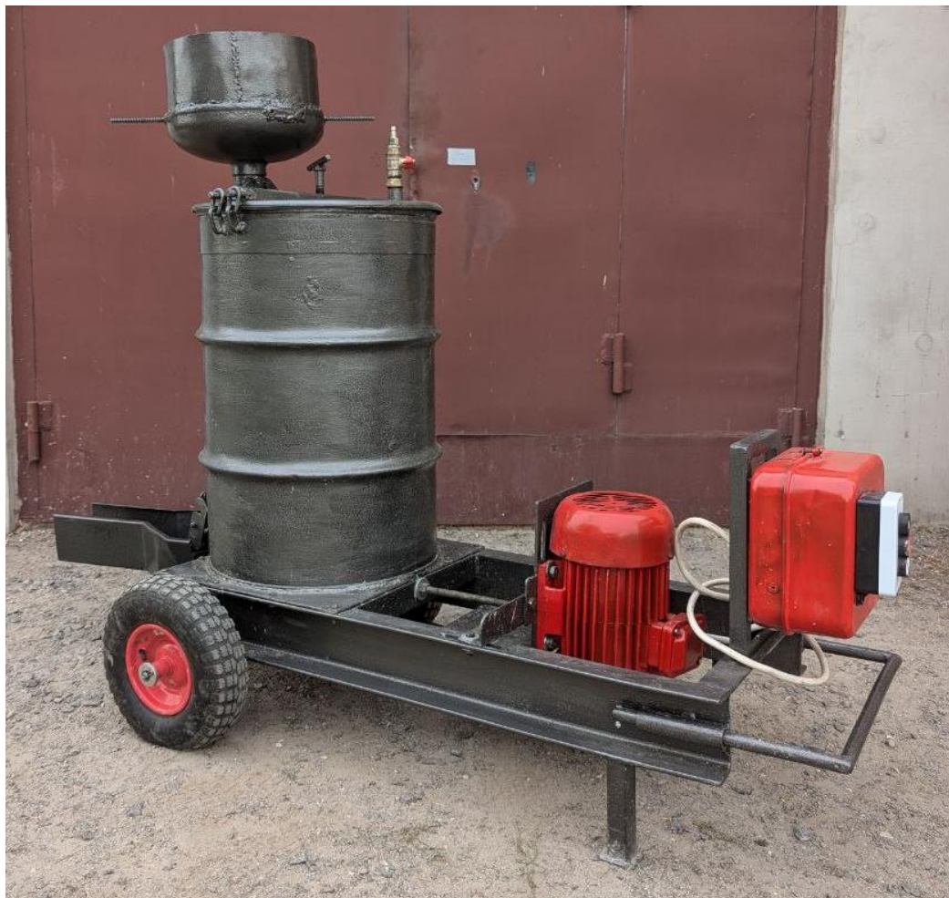
Рисунок 4.1 – Загальний вигляд дослідного зразка установки для приготування ніздрюватих бетонів (УдПНБ-100)
