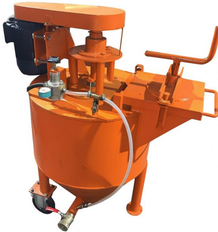
Рисунок 1.6 – Змішувач ніздрюватих бетонів ПБУ-200
