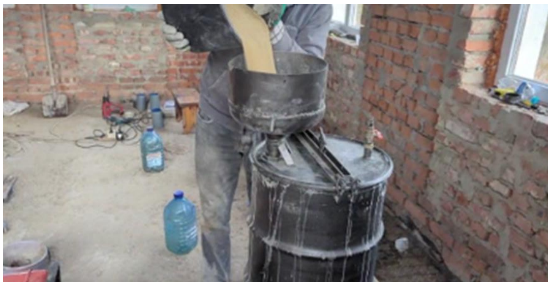
Рисунок 3.12 – Завантаження компоненті суміші до змішувального бункеру
