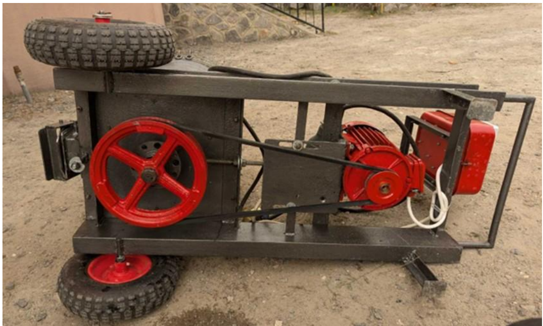
Рисунок 3.2 – Розміщення шківів на двигуні та валу робочого органу
