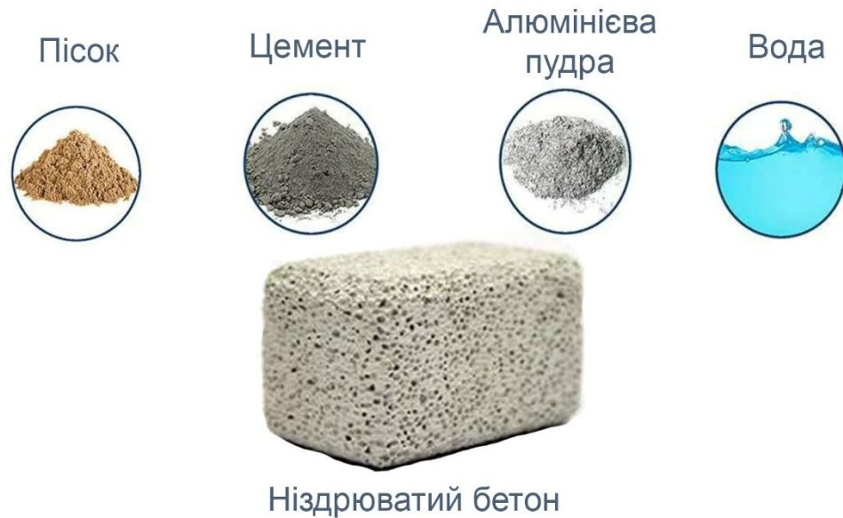
Рисунок 1.1 – Склад ніздрюватих бетонів
