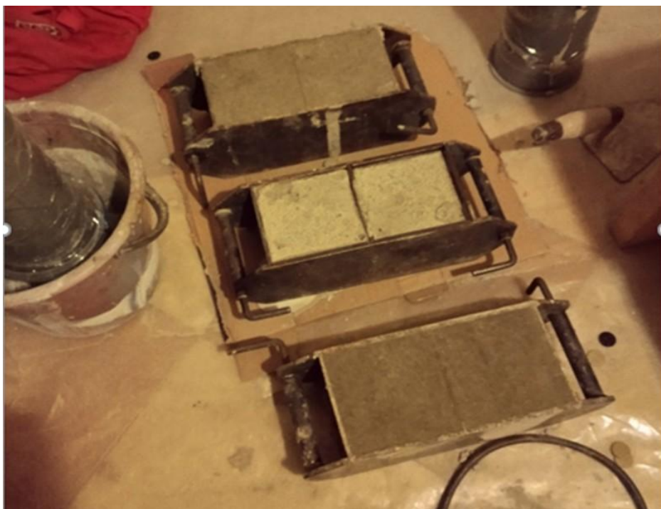
Рисунок 3.15 – Загальний вигляд дослідних зразків ніздрюватого бетону у формах
