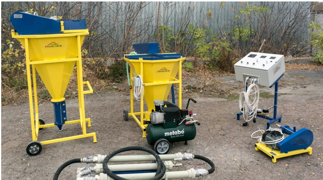
Рисунок 1.7 – Комплекс для виробництва ніздрюватих бетонів «FCM 5».
