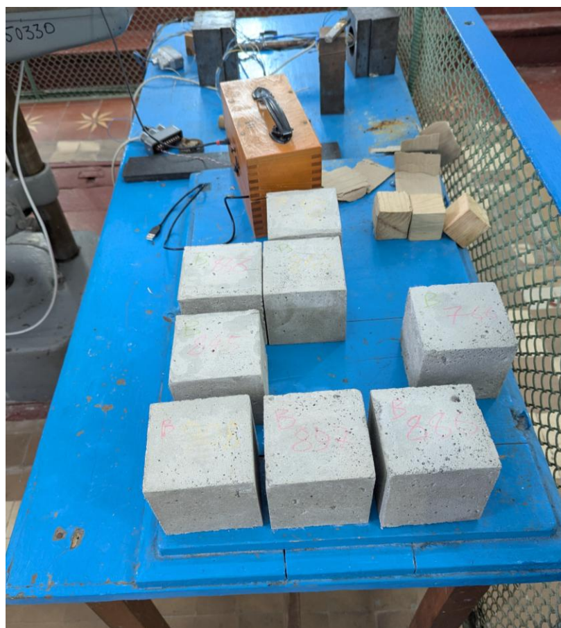
Рисунок 3.19 – Дослідні зразки ніздрюватого бетону 100×100×100 мм
