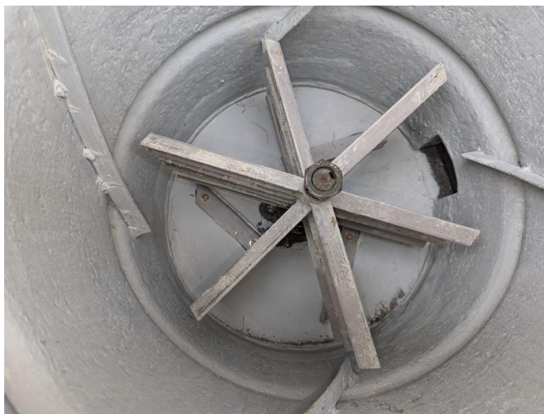
Рисунок 4.3 – Робочі органи бетонозмішувача УдПНБ-100
