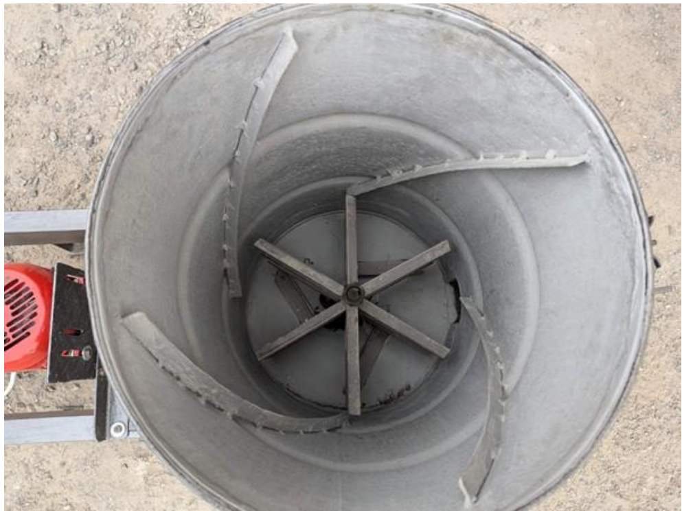
Рисунок 3.4 – Робоча камера змішувального бункера з встановленим робочим органом
