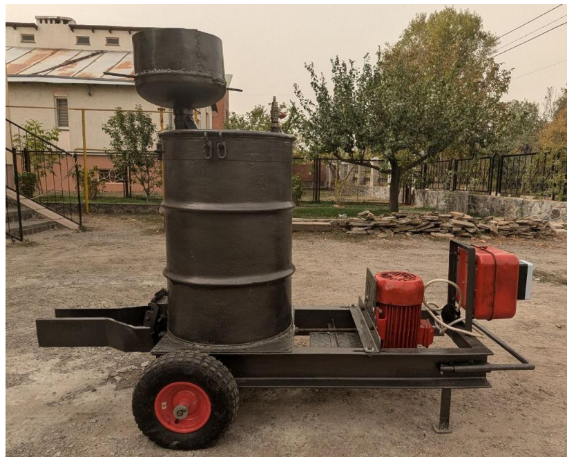
Рисунок 3.1 – Виготовлена установка для приготування ніздрюватих бетонів (натурний зразок)
