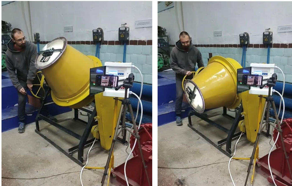
Рис. 1. Дослідний зразок бетонозмішувального обладнання з осциляційним рухом барабана
