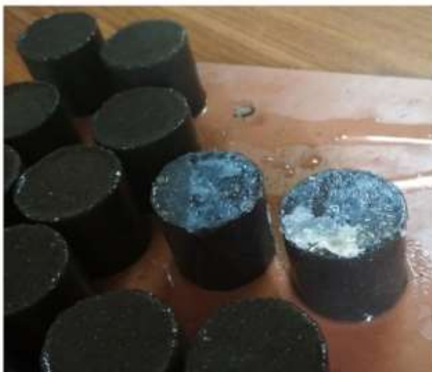
Рисунок 5.28 Кристалики солей на поверхні зразків виготовлених з бурового шламоцементу після водонасичення.
