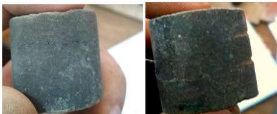
Рисунок 5.29, 5.30 Утворення тріщин у зразках бурового шламоцементу з найбільшим і найменшим вмістом води та цементу, без використання добавки.
