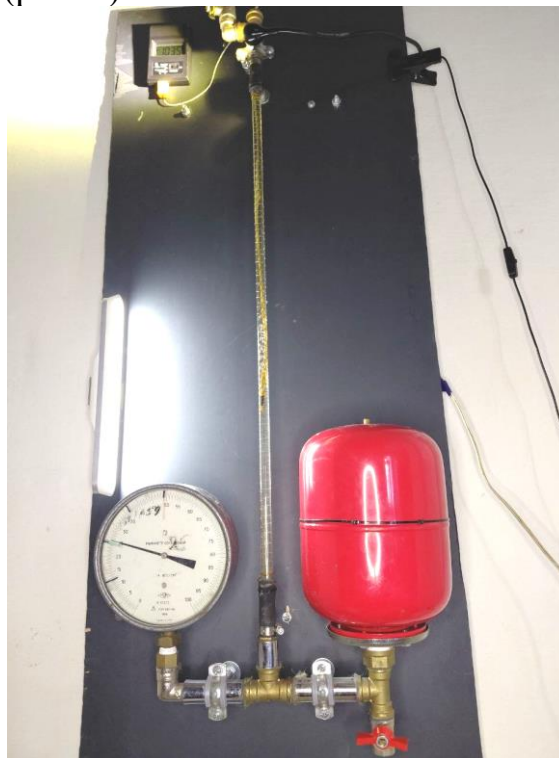
Рис. 1. Конструкція лабораторного стенда для дослідження процесу стагнації
