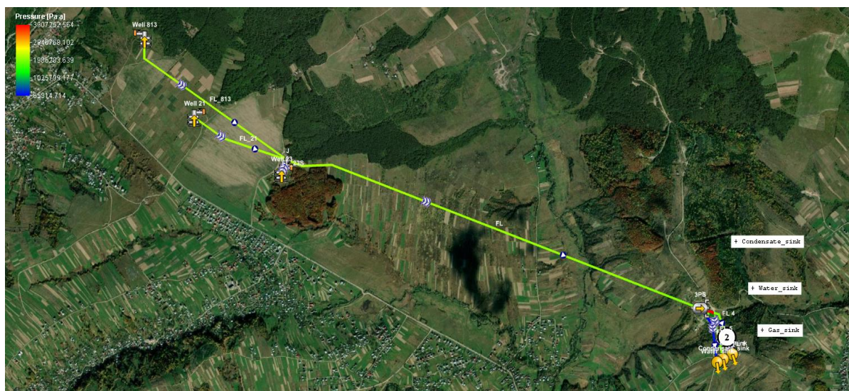
Рис. 1. Розподіл тиску в поверхневій системі збору вуглеводнів
