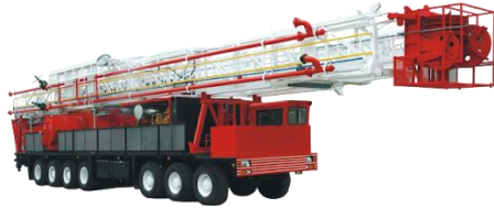
Рис. 2.164 Мобільний верстат ZJ40
