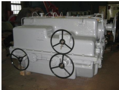
Рис. 2.80 Коробка передач КПЗ-900Д
