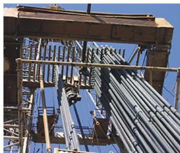
Рис. 2.9 Свічки встановлені за «палець»
