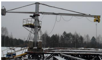
Рис. 2.66 Кран консольно-поворотний КПБ-3
