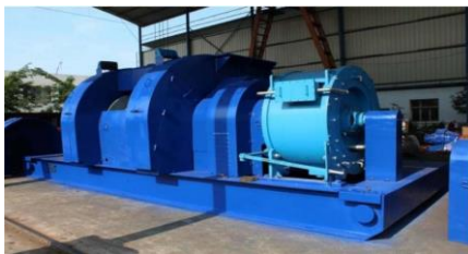
Рис. 2.151 Електропривід бурової лебідки
