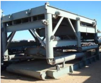
Рис. 2.14 Основа мобільних верстатів
