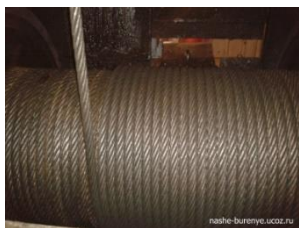
Рис. 2.34 Талевий канат на барабані Рис. 2.35 Шестипасмовий канат Рис. 2.36 Розріз каната
