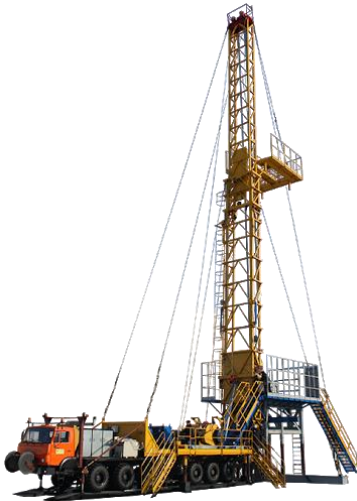
Рис. 2.166 Мобільний верстат ZJ20
