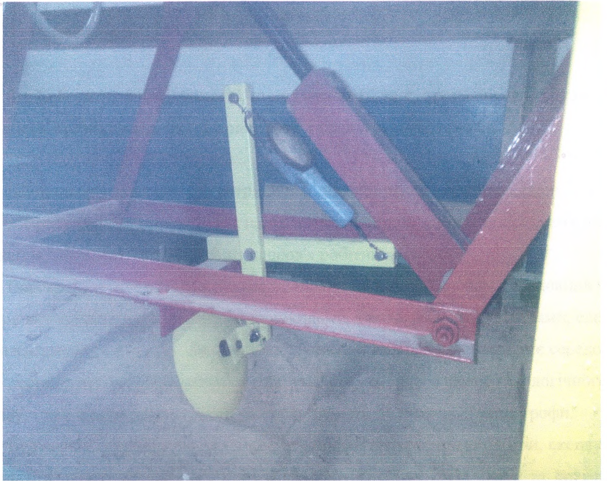
Рисунок 3.6 – Процес вимірювання нормальної складової зусилля N при різанні ґрунту моделлю дискового ножа грейдер – елеватора
