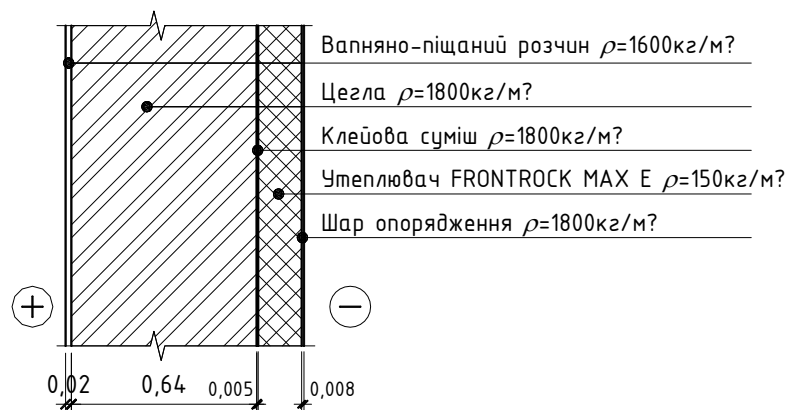
Рис. 3.3 – Конструкція стіни після термомодернізації.
