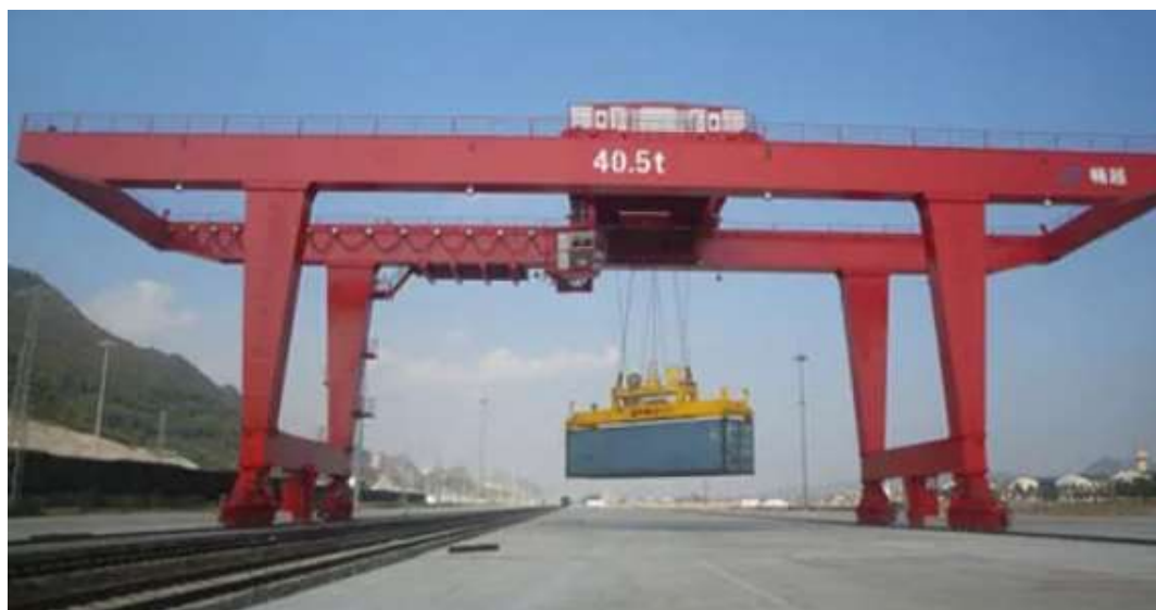
Рисунок 1.4 – Козловий контейнерний кран під час перевантаження контейнера
