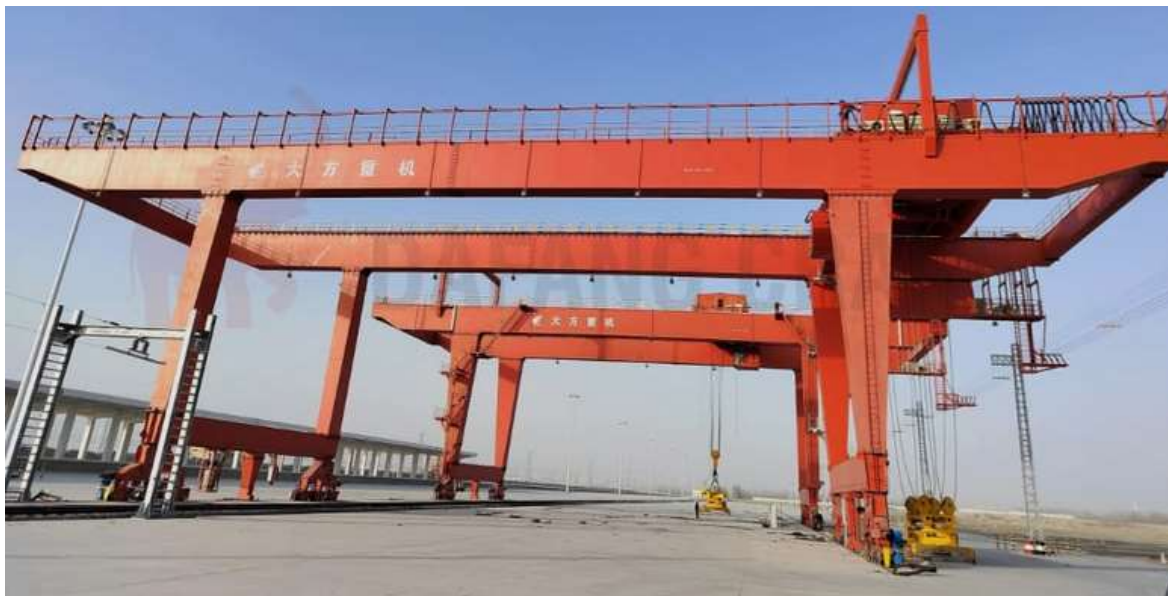
Рисунок 1.1 – Загальний вигляд козлових контейнерних кранів на термінальному майданчику
