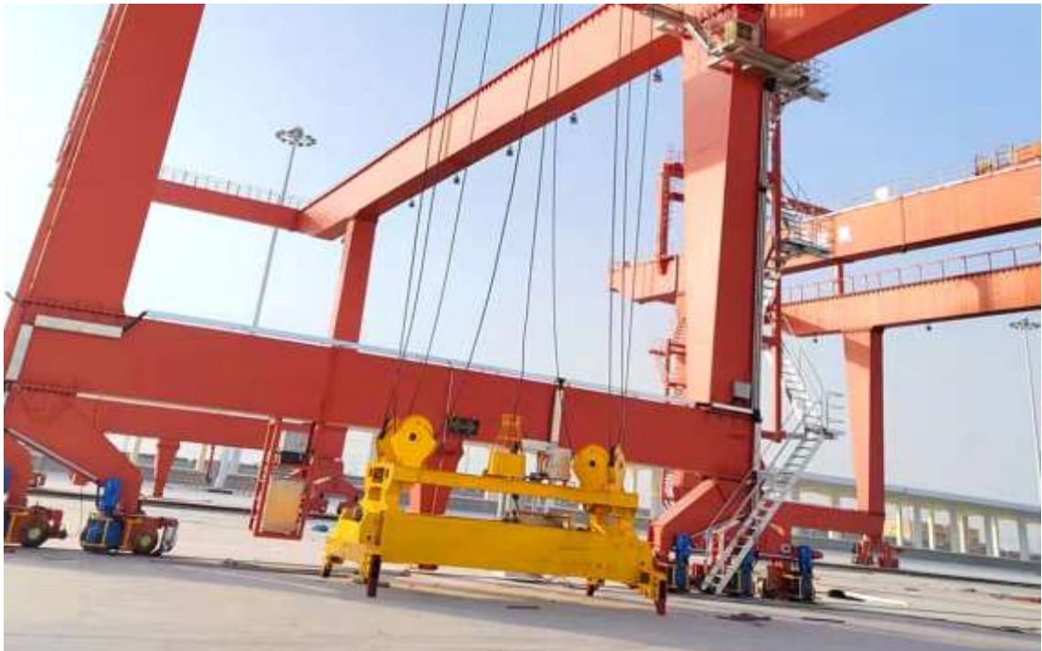
Рисунок 1.2 – Вантажний візок та спредер козлового контейнерного крана
