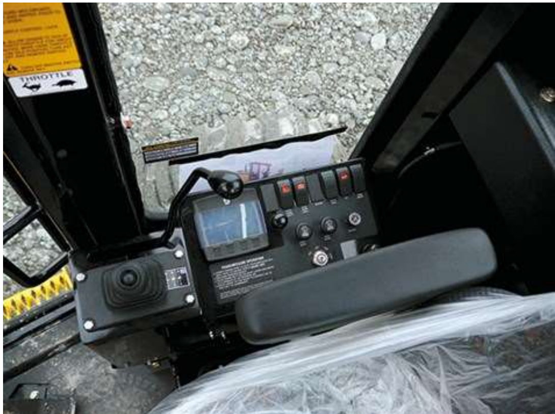
Рисунок 1.4 – Розміщення органів керування автогрейдером у кабіні оператора
