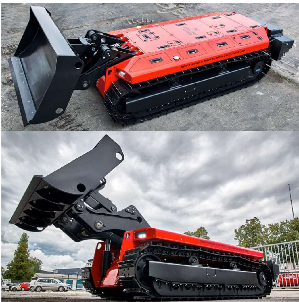
Рисунок 1.2 – Роботизована гусенична платформа з навісним бульдозерним обладнанням
