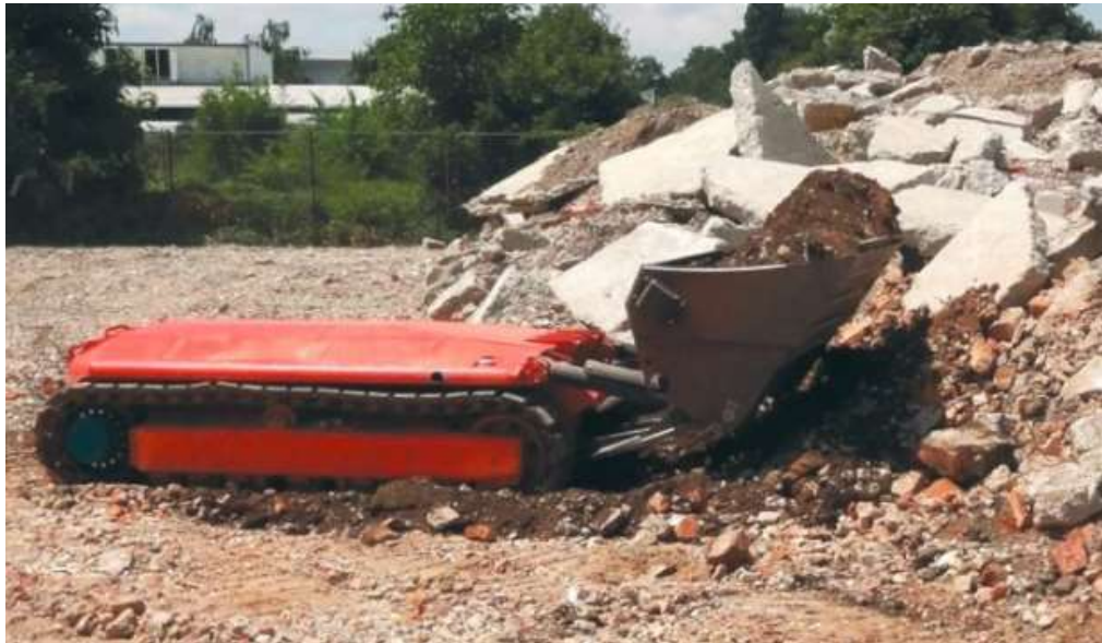
Рисунок 1.5 – Роботизована гусенична машина DOK-ING із переднім робочим обладнанням
