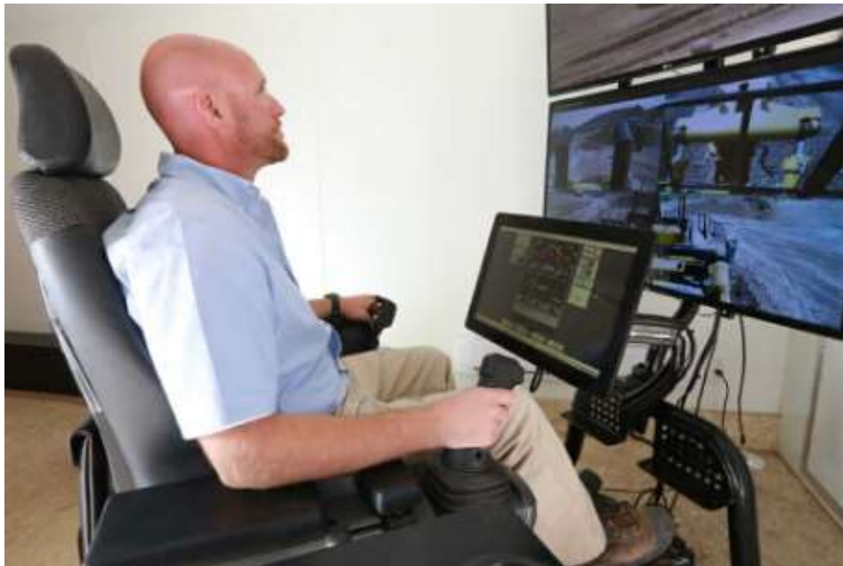
Рисунок 1.4 – Приклад дистанційного керування бульдозером
