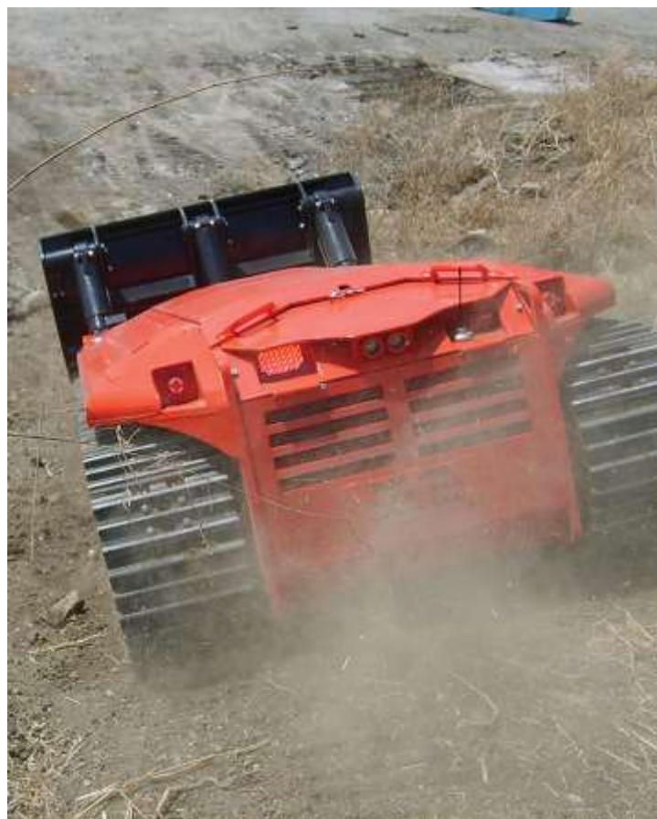
Рисунок 1.3 – Відвал роботизованої гусеничної машини з посиленою робочою кромкою
