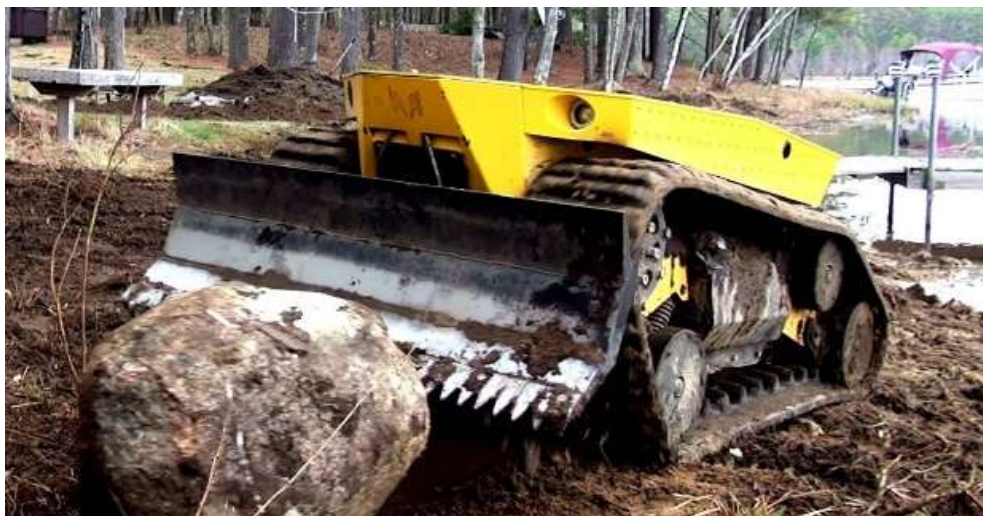
Рисунок 1.1 – Компактна гусенична роботизована машина з переднім бульдозерним відвалом
