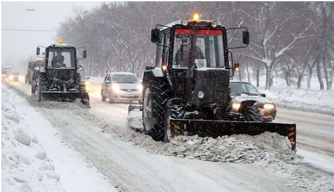
Рисунок 1.1 – Очищення проїзної частини тракторними плужними снігоочисниками під час інтенсивного снігопаду
