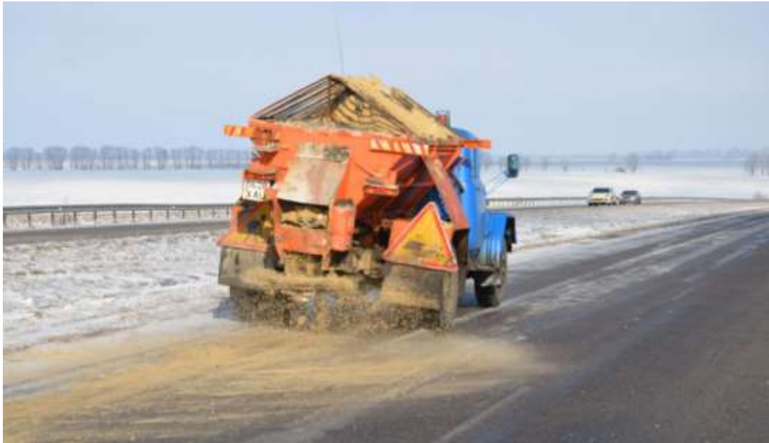
Рисунок 1.5 – Розподілення піщано-соляної суміші на автомобільній дорозі
