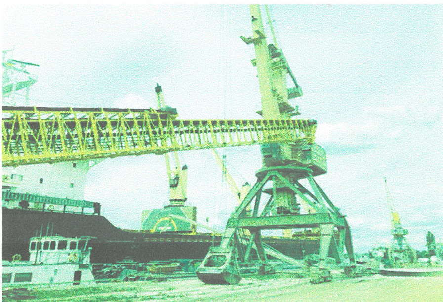
Рисунок 1.7 – Розміщення стрічкового телескопічного конвеєра відносно судна та причального обладнання
