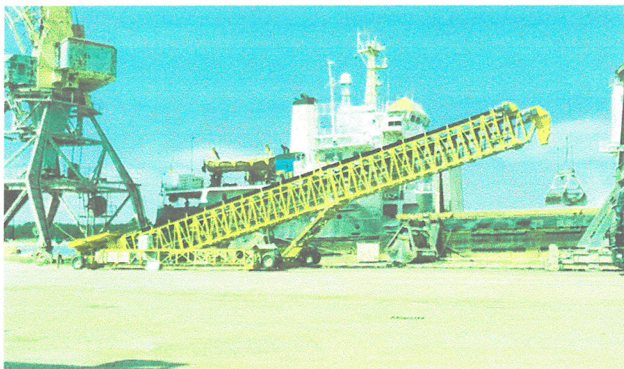
Рисунок 1.6 – Стрічковий телескопічний конвеєр судозавантажувальної машини під час роботи біля причалу
