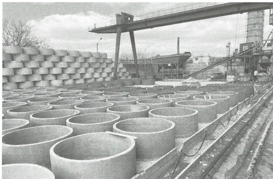
Рисунок 1.4 – Виробничий майданчик для виготовлення та складування залізобетонних кілець
