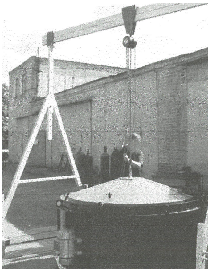
Рисунок 1.10 – Формувальна установка для виготовлення залізобетонних кілець
