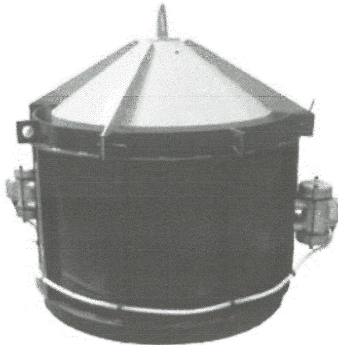
Рисунок 1.11 – Установка для формування залізобетонних кілець з навісними вібробудниками
