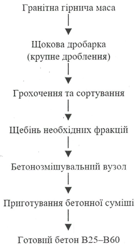
Рисунок 1.1. Схема технологічного процесу виробництва бетону
