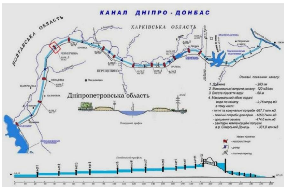
Рис. А.2. Офіційна схема траси магістрального каналу Дніпро–Донбас та вузлів його гідротехнічної взаємодії з русловою системою річки Оріль
