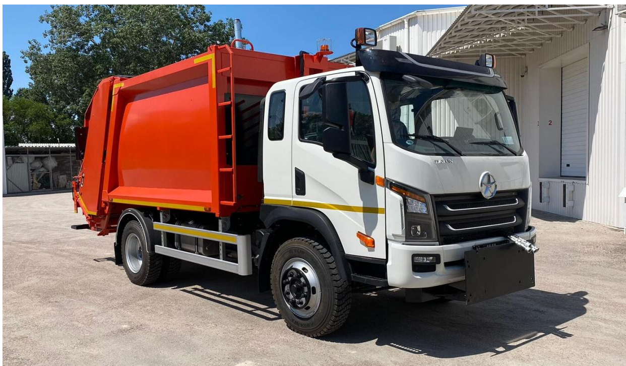
Рисунок. 4. Автомобіль сміттєвоз із заднім механізованим завантаженням АТ-4021 з об'ємом кузова 11м 3 (передній відвал навішується за необхідності)
