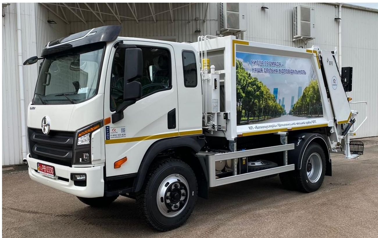
Рисунок. 5. Автомобіль сміттєвоз із заднім механізованим завантаженням АТ-4021 з об'ємом кузова 8м 3
