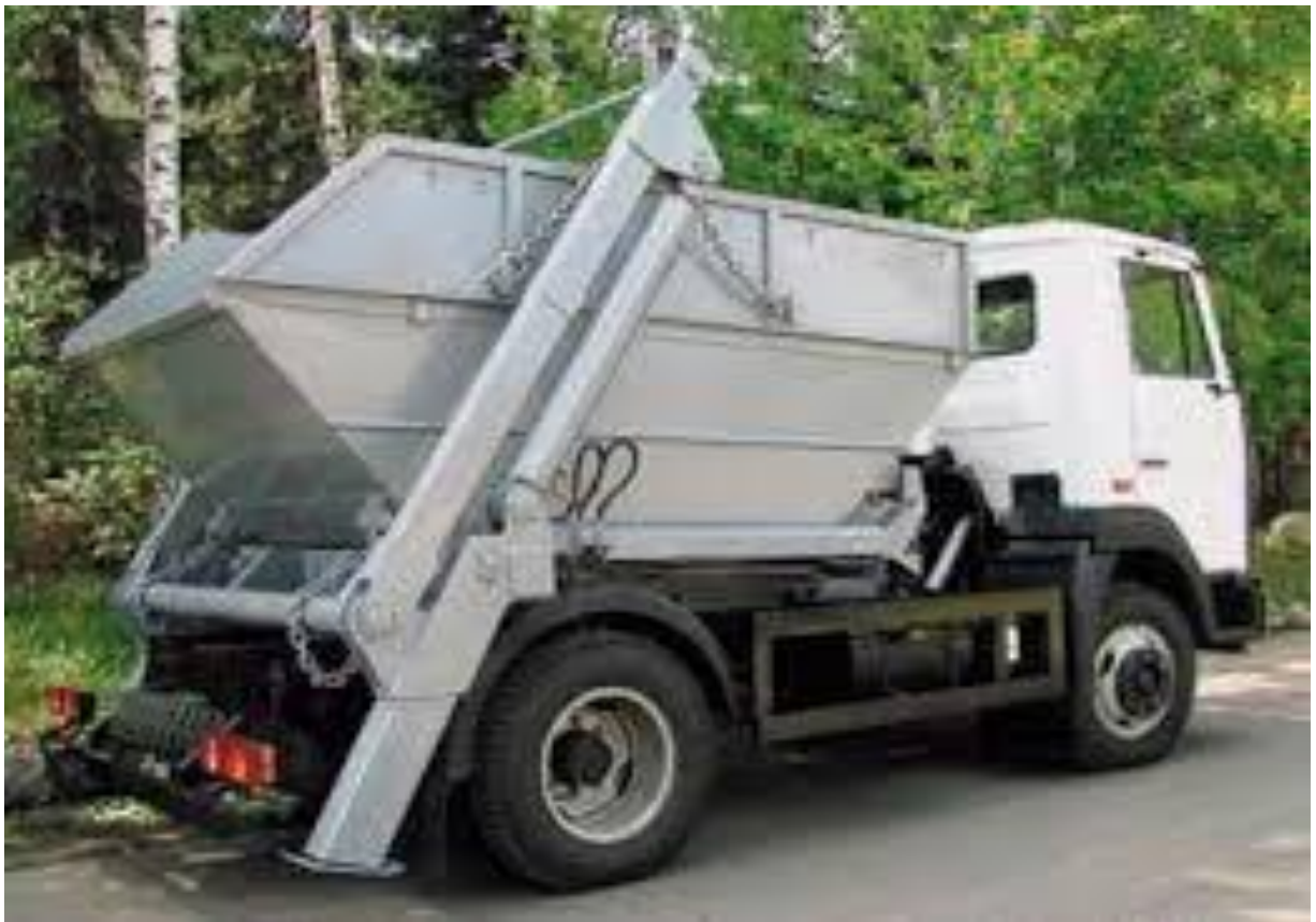
Рис. 6. Сміттевоз-мультиліфт з контейнером об'ємом 8м 3
