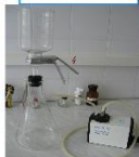
Установка для проведення мембранної фільтрації води (п.2-п.6)
