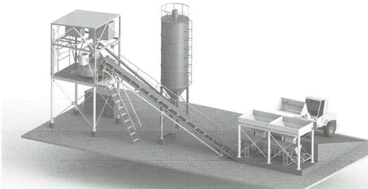
Рисунок 1.6 – Загальний вигляд бетонозмішувального вузла для приготування бетонної суміші
