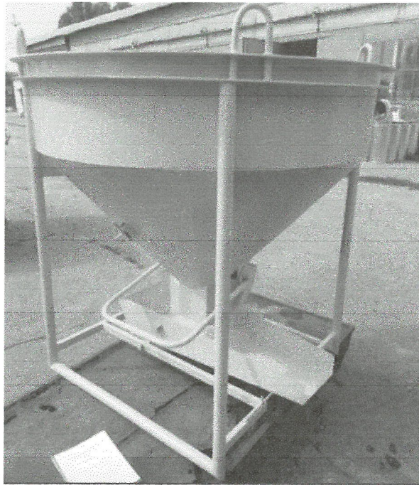
Рисунок 1.7 – Подача бетонної суміші до форми за допомогою бункера або бадді
