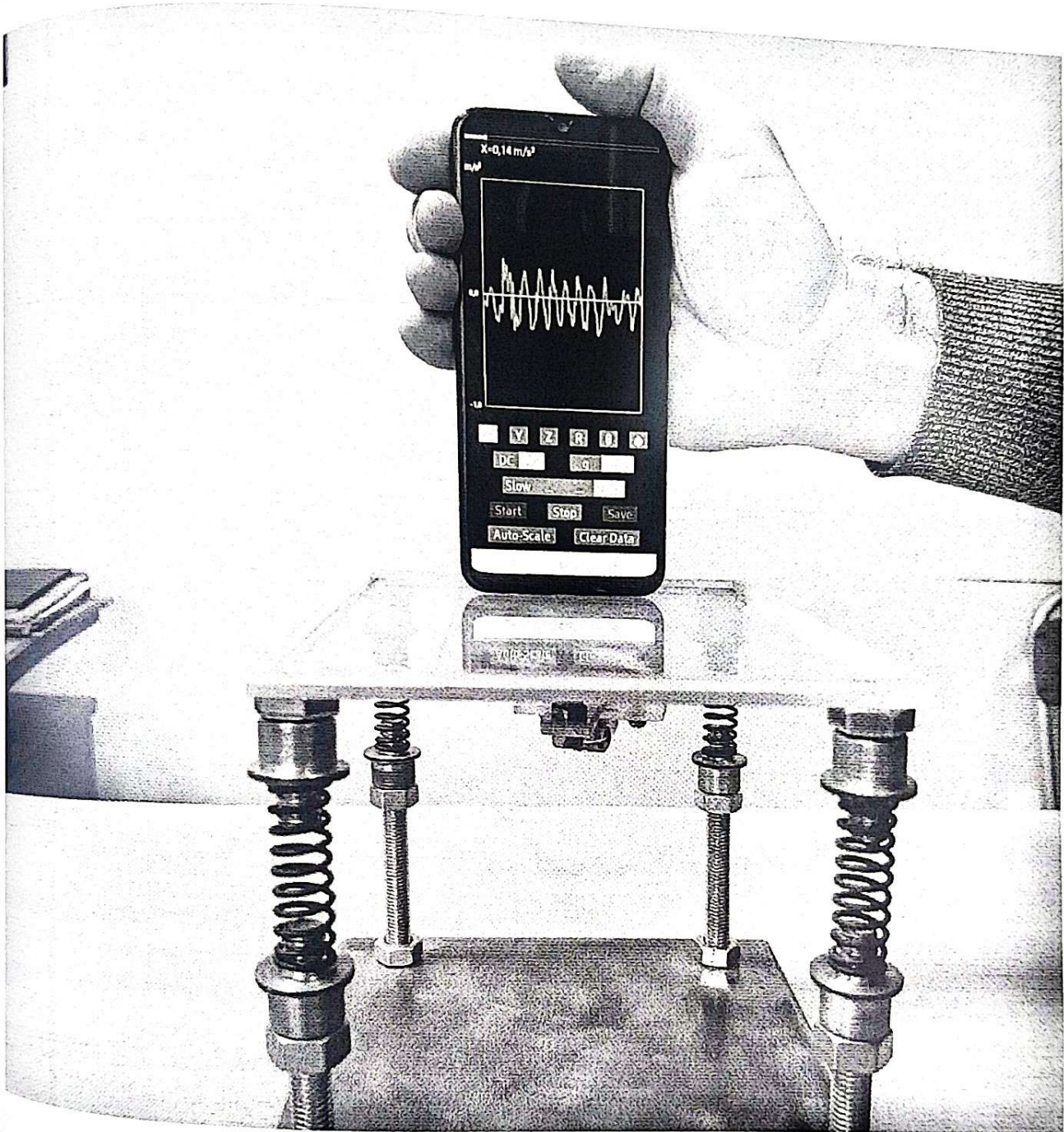
Рис. 3.5 Процес вимірювання амплітуди коливань на дослідній моделі.
