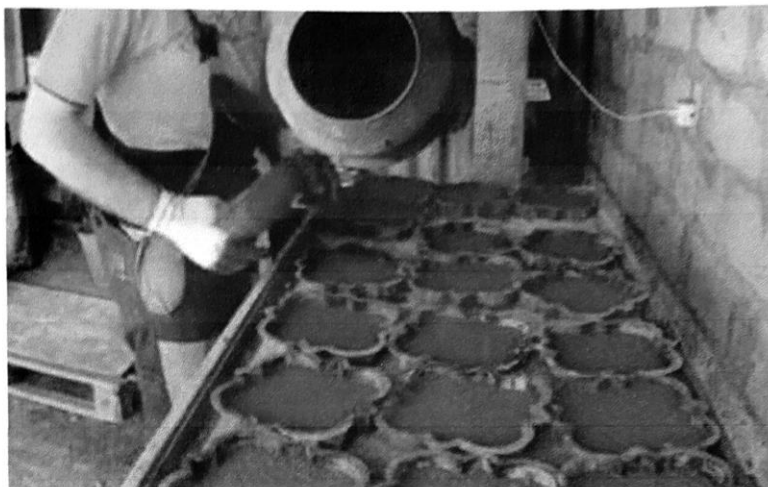
Рисунок 1.3 – Загальний вигляд вібраційного столу з формами, встановленими без жорсткого кріплення
