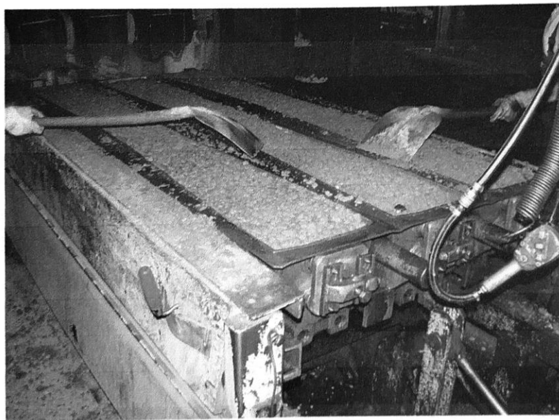
Рисунок 1.6 – Вібраційний стіл з гладкою робочою поверхнею та формою без жорсткого кріплення
