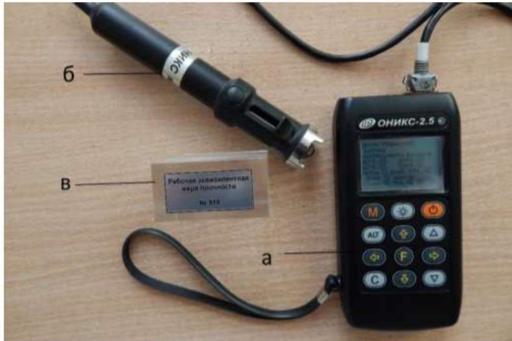
Рис. 3.5. Вимірювач міцності будівельних матеріалів "ОНИКС - 2.5": а - електронний блок вимірювань; б - датчик-склерометр; в - еталон з органічного скла
