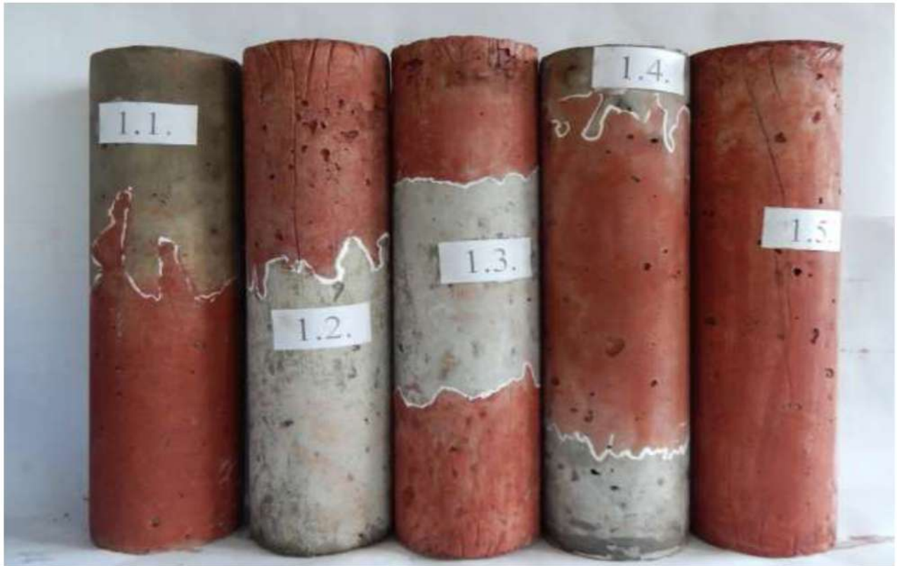
Рис. 5.5. Серія зразків циліндрів бетонних висотою 4d з введенням пігменту
