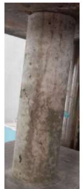
Рисунок 5.10. Характер руйнування зразків циліндрів серії 1.5.
