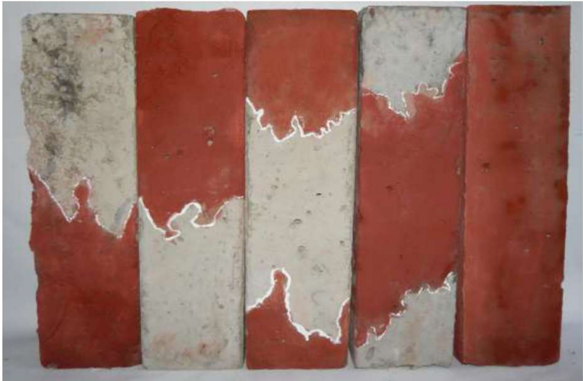
Рис. 5.12. Серія зразків призм бетонних висотою 400 мм з введенням пігменту
