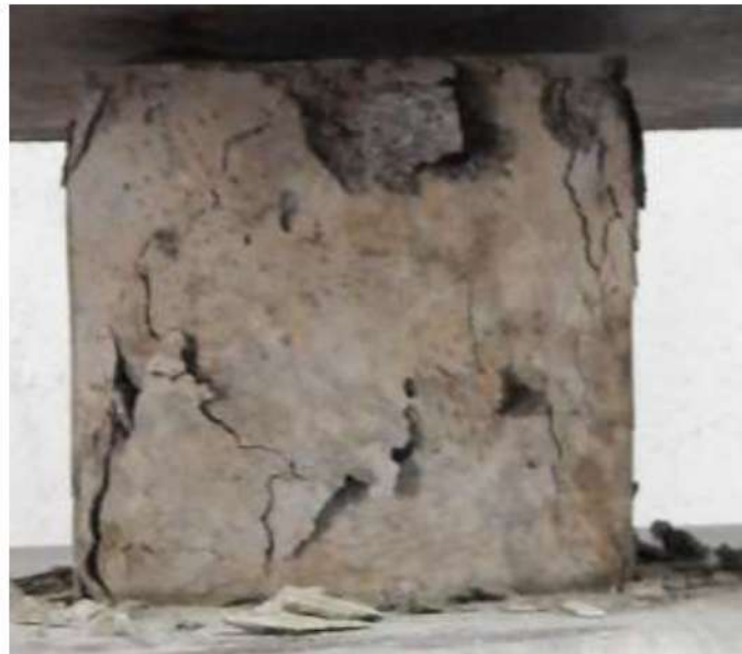
Рисунок 5.12. Зразки кубу після випробувань
