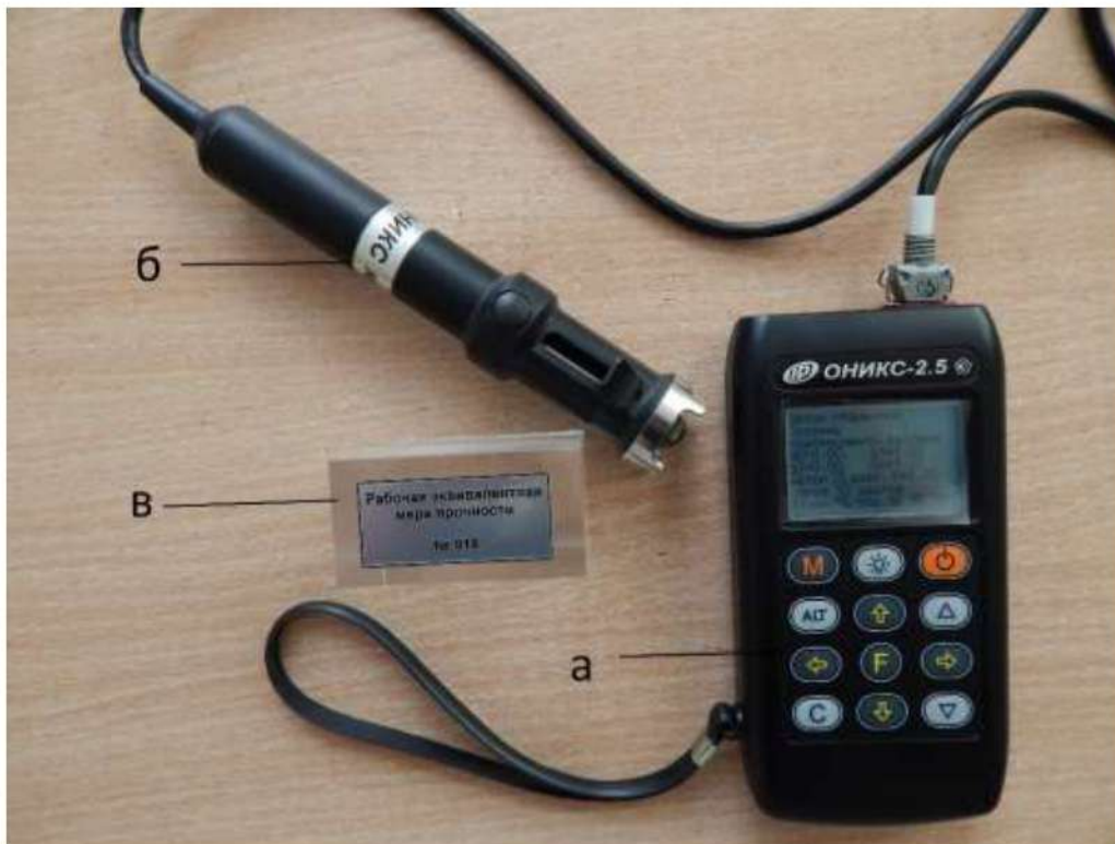
Рис. 3.5. Вимірювач міцності будівельних матеріалів "ОНИКС - 2.5": а - електронний блок вимірювань; б - датчик-склерометр; в - еталон з органічного скла
