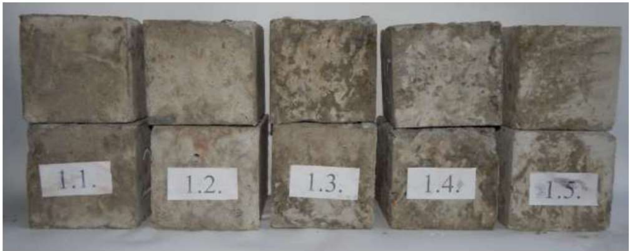
Рис. 5.14. Серія експериментальних зразків-кубиків з довжиною ребра 150 мм
