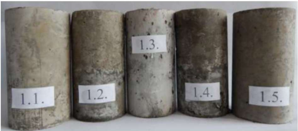
Рис. 5.4. Серія зразків циліндрів бетонних
