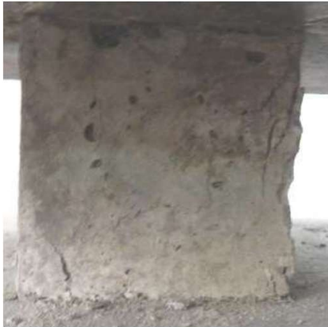
Рисунок 5.16. Зразки кубу після випробувань
