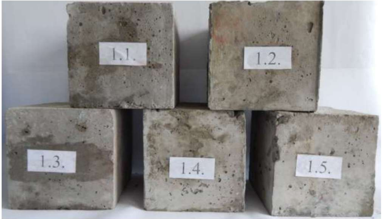
Рис. 5.10. Серія експериментальних зразків-кубиків з довжиною ребра 150 мм
