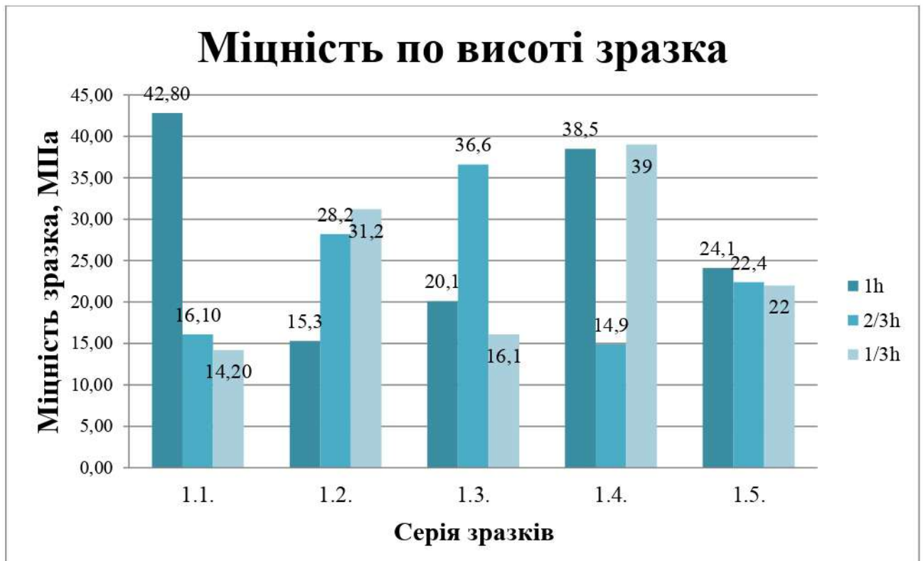
Рисунок 5.15. Графік коливання середньої міцності по висоті зразків серії
