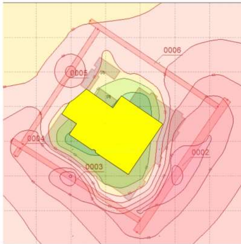
Рис. 42 Еквівалентна карта шуму на якій відмічена територія з рівнем звукового тиску, що відповідає нормованому значенню 55дБ при збільшення відстані від будинку до магістральної вулиці на 10 м.
