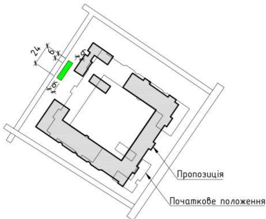
Рис. 49 Планувальне рішення житлової групи, після застосування всіх необхідних заходів які забезпечують виконання норм з рівня шуму на всій території двору
