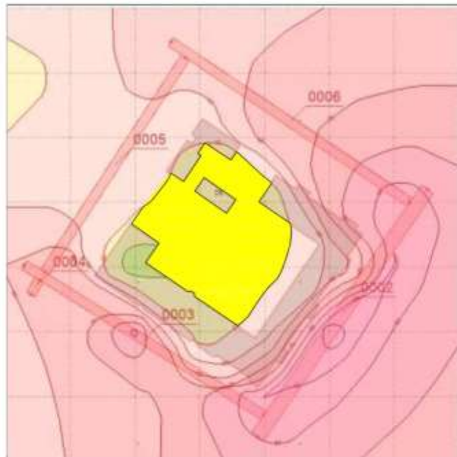
Рис. 29 Еквівалентна карта шуму на якій відмічена територія з рівнем звукового тиску, що відповідає нормованому значенню 55дБ після повороту на 180°.
