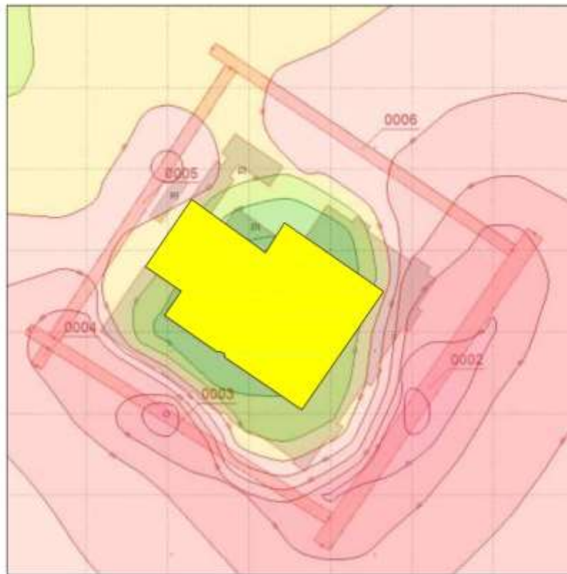
Рис. 48 Еквівалентна карта шуму на якій відмічена територія з рівнем звукового тиску, що відповідає нормованому значенню 55дБ при зміщенні шумозахисного озеленення праворуч на 6 м
