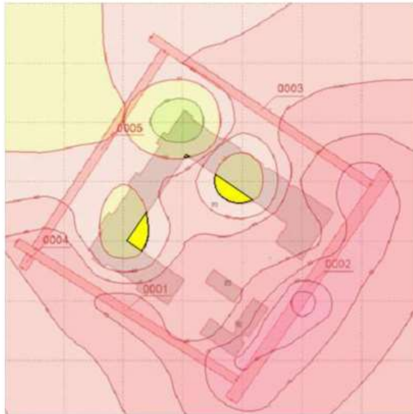
Рис. 21 Еквівалентна карта шуму на якій відмічена територія з рівнем звукового тиску, що відповідає нормованому значенню 55дБ
