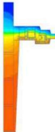
Рис. 37 – Температурне поле розрахункової схеми
