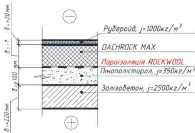
Рисунок – 4.3 Розрахункова схема утепленого покриття
