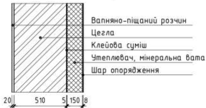
Рисунок 4.4 - Конструкція зовнішньої стіни
