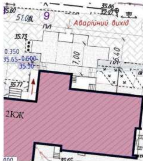
Фрагмент з аварійним виходом у осі Н.
