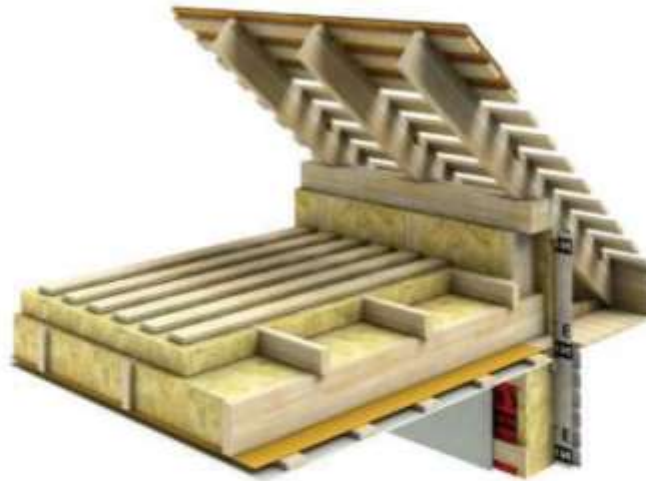
Рис. 3 Утеплення горищного перекриття.
