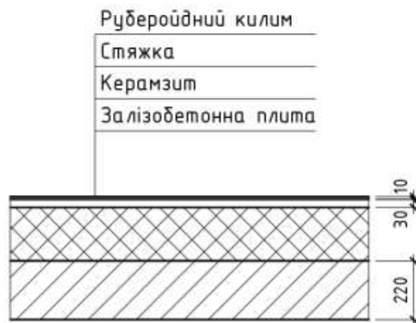
Рис. 14 Конструкція суміщеного покриття
