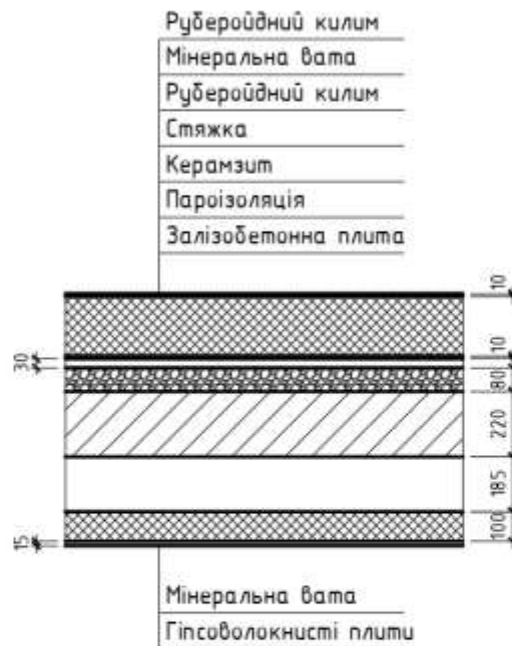
Рис 49 Конструкція суміщеного покриття
