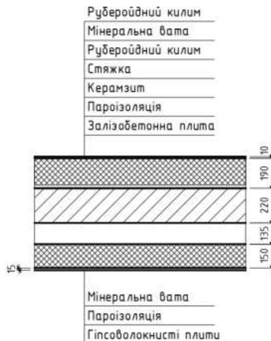
Рис 86 Конструкція суміщеного покриття
