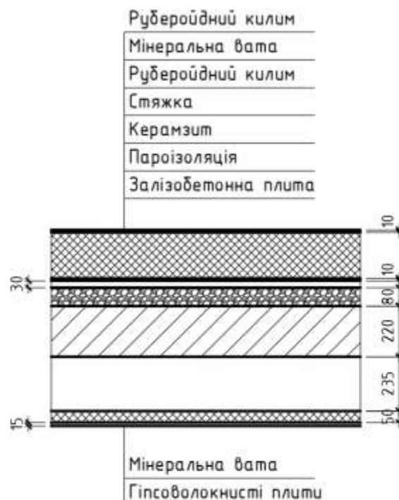
Рис 47 Конструкція суміщеного покриття
