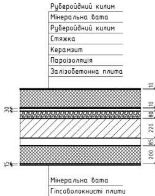
Рис 53 Конструкція суміщеного покриття
