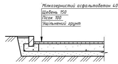
Конструкція дорожнього покриття проїзду (тип 1)
