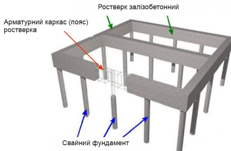
Рис 3.2.1. Схема армування та складових пальового фундаменту
