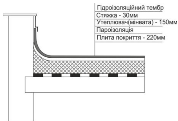
Рис. 3.9.1 Конструкційна схема покриття даху
