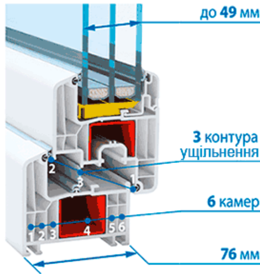
Рис. 3.5. Віконний 6-камерний ПВХ профіль [60]
