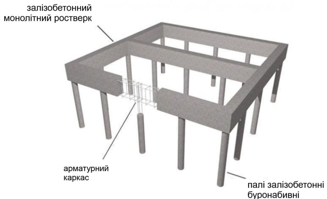
Рис. 3.2.1.1 Пальово-стрічковий фундамент
