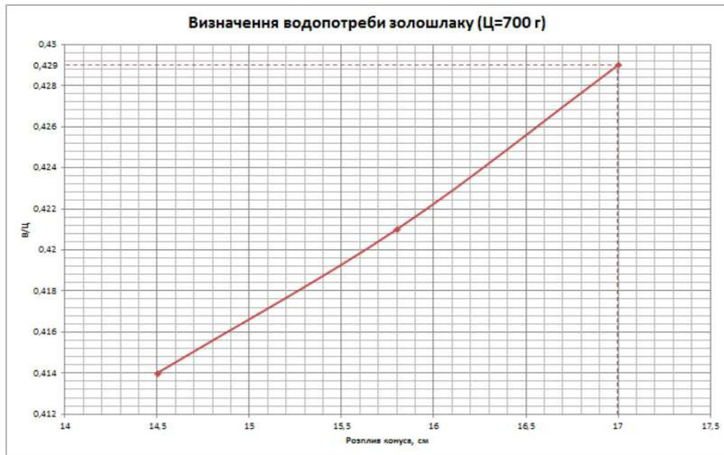
Рис. 4.2. Крива визначення водопотреби золи при Ц=700 г
