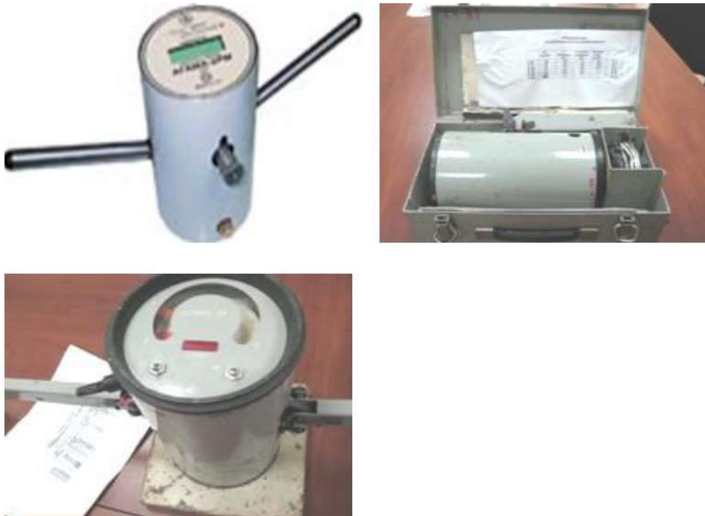
Рис.3.3. Вимірювання водонепроникності та морозостійкості експрес-методом за допомогою приладу АГАМА-2Р: а - у – загальний вигляд приладу АГАМА-2Р; г – процес виміру.
