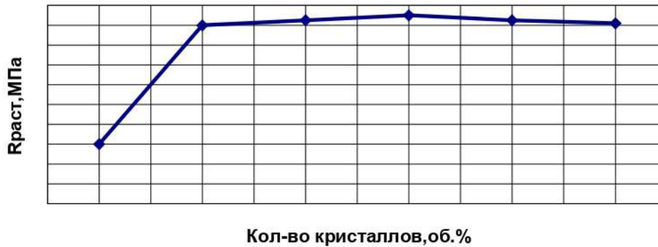
Рис. 1.1. Зміна міцності цементного каменю від об'ємного вмісту ниткоподібних кристалів
