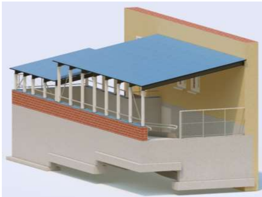
Рис. 5.12. – Загальний ортогональний вид пандуса
