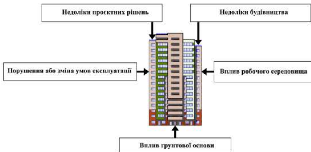
Рис.4.8. – Чинники виникнення дефектів та пошкоджень. Перехід конструкцій або БтаС у цілому в аварійний стан може бути спричинений як одним чинником, так і сукупністю декількох.
