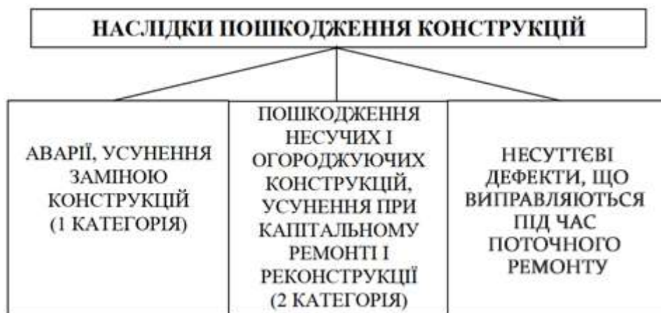
Рис.4.3. – Наслідки ушкодження конструкцій
