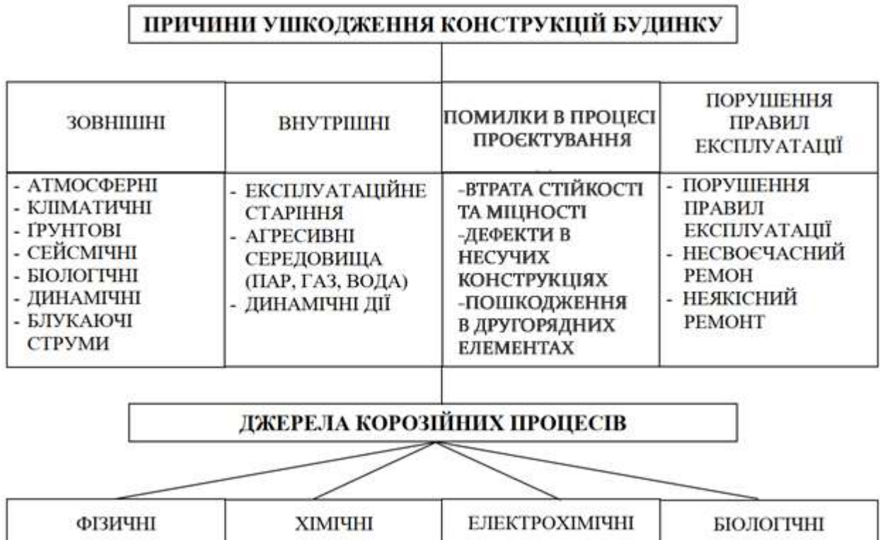
Рис.4.2. – Причини ушкодження конструкцій будівель (джерела корозійних процесів)
