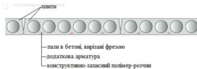
Рис. 4.15. – Процес підсилення багатопустотної плит шляхом монтажу додаткової арматури на полімер-розчині
