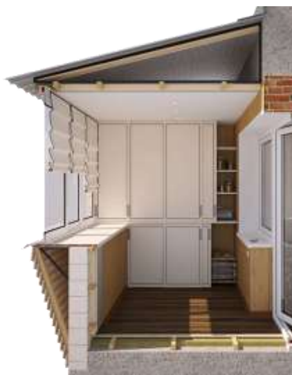
Рис. 5.9. – Реконструкція балкону з розширенням
