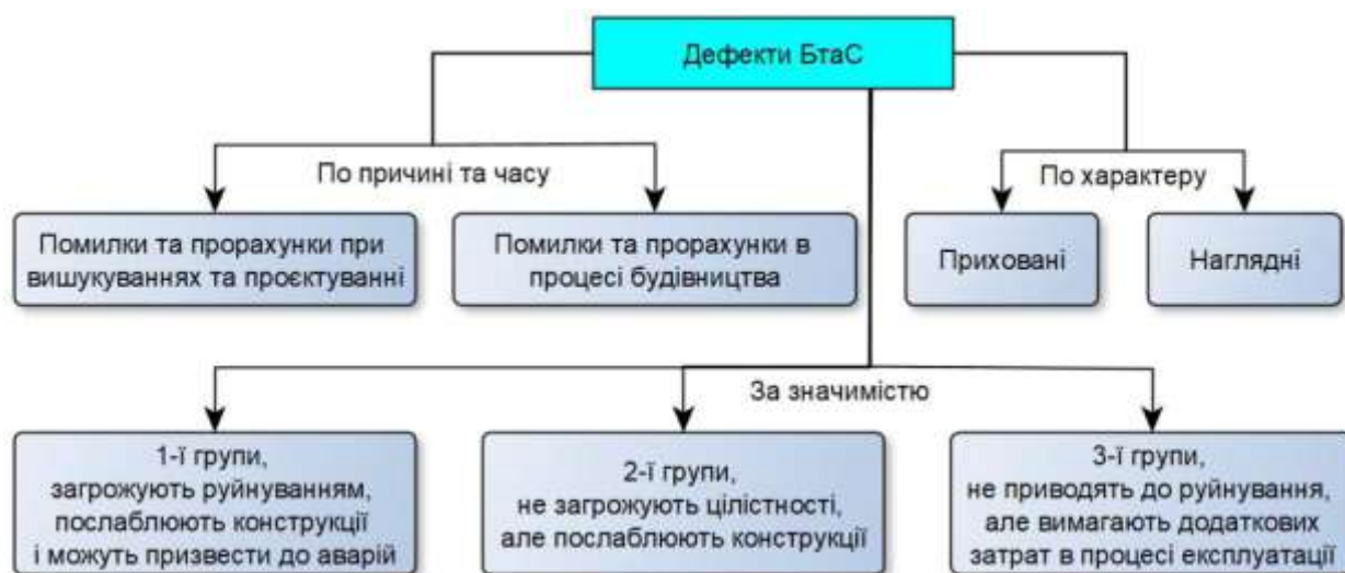
Рис. 4.7. – Класифікація дефектів будівлі
