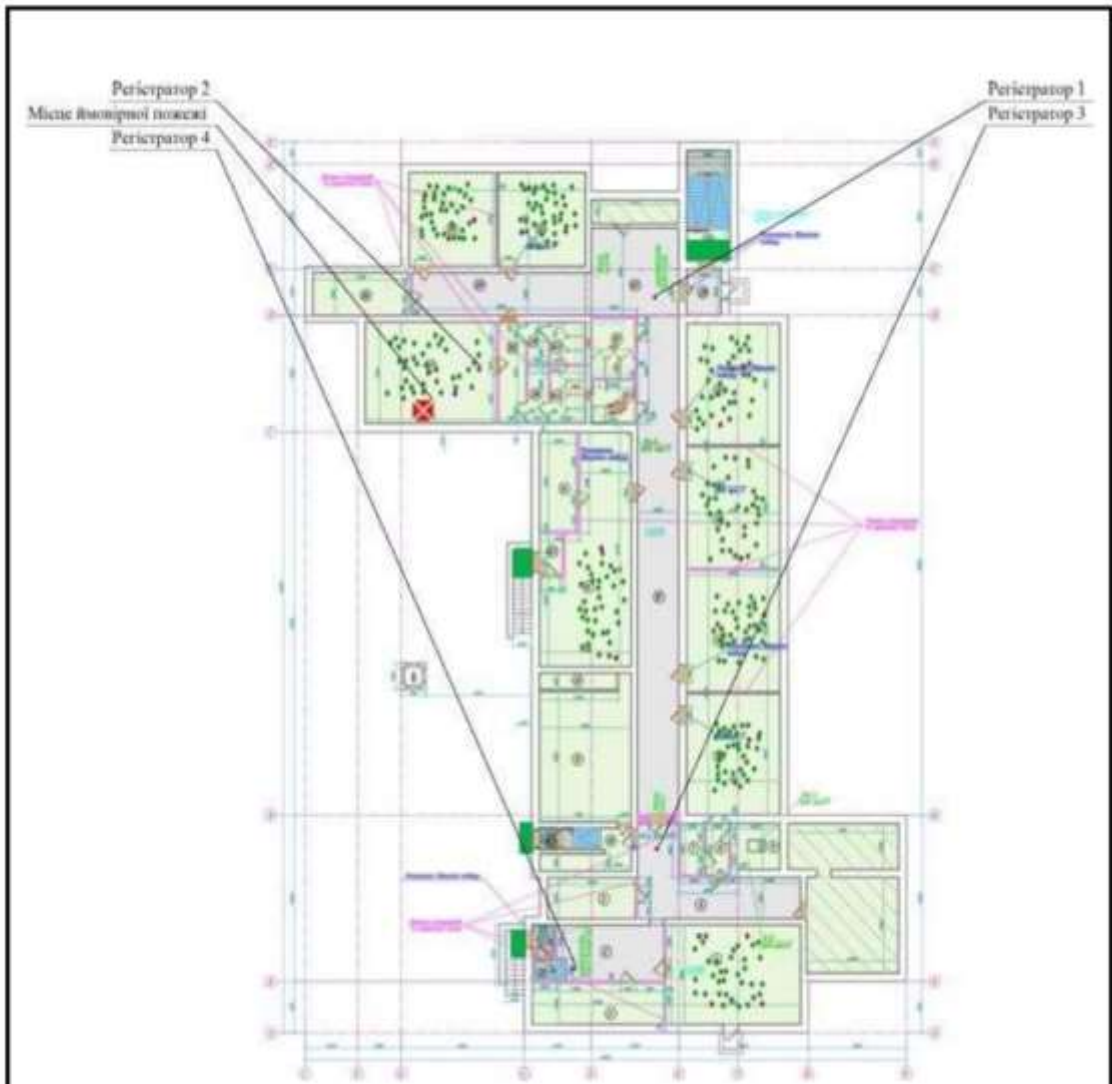
Розрахункова схема поверху будівлі з місцями розміщення вогнища ймовірної пожежі в приміщеннях, розрахунковими точками вимірювання НЧП для Сценарій 1.
