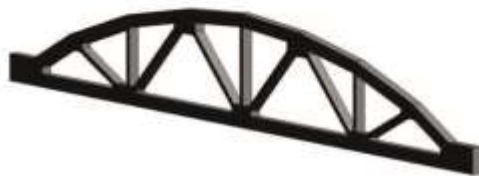
Залізобетонна сегментна ферма
